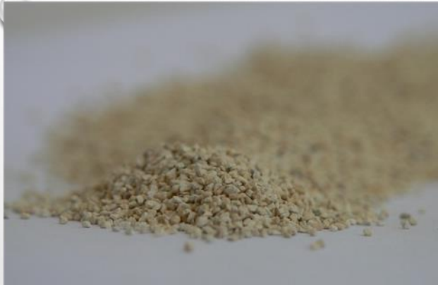
Uzorak prirodnog zeolita klinoptilolita veličine čestica 0,6 - 0,8 mm.
