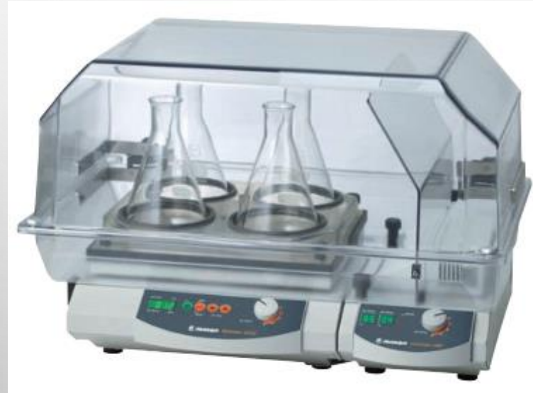
Inkubatorska tresilica „Heidolph Unimax 1010“.
