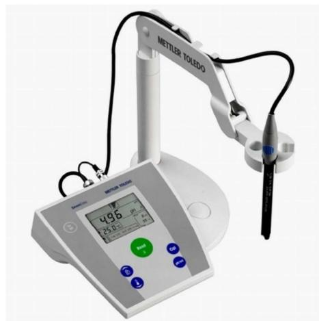
Slika 2.3. pH metar „Mettler Toledo“.
