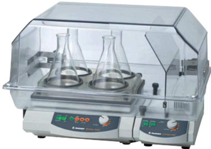
Slika 2.2. Inkubatorska tresilica „Heidolph Unimax 1010“.
