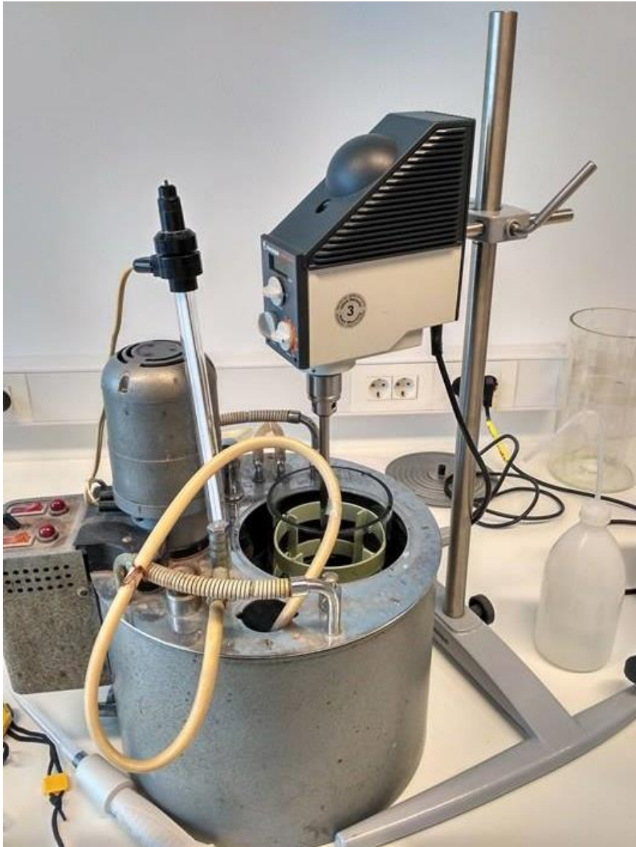
Slika 6. Aparatura za provedbu ionske izmjene - kotlasti reaktor s termostatom i miješalicom
