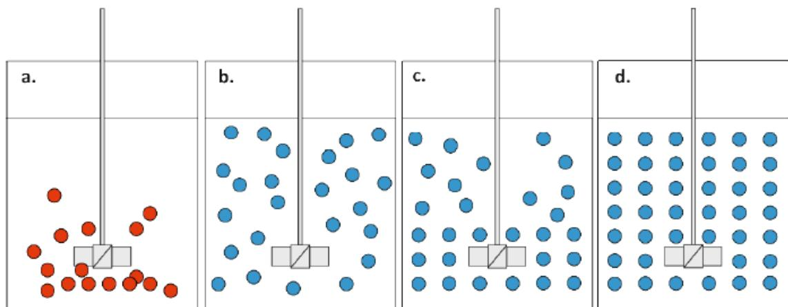
*Slika 3. Stanja suspenzije: a. nepotpuna suspenzija, b. potpuna suspenzija, c. intermedijalna suspenzija, d. homogena suspenzija<sup>(5)</sup>*
