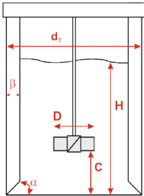
*Slika 7. Osnovne geometrijske karakteristike reaktora za suspendiranje*
