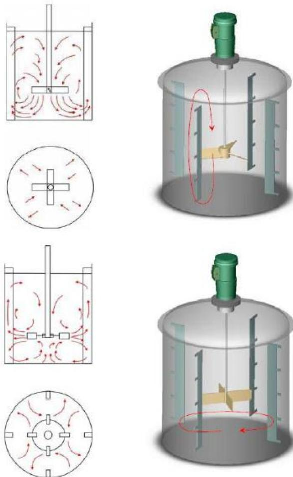
*Slika 2.* Prikaz aksijalnog i radijalnog toka kapljevine <sup>(1)</sup>
