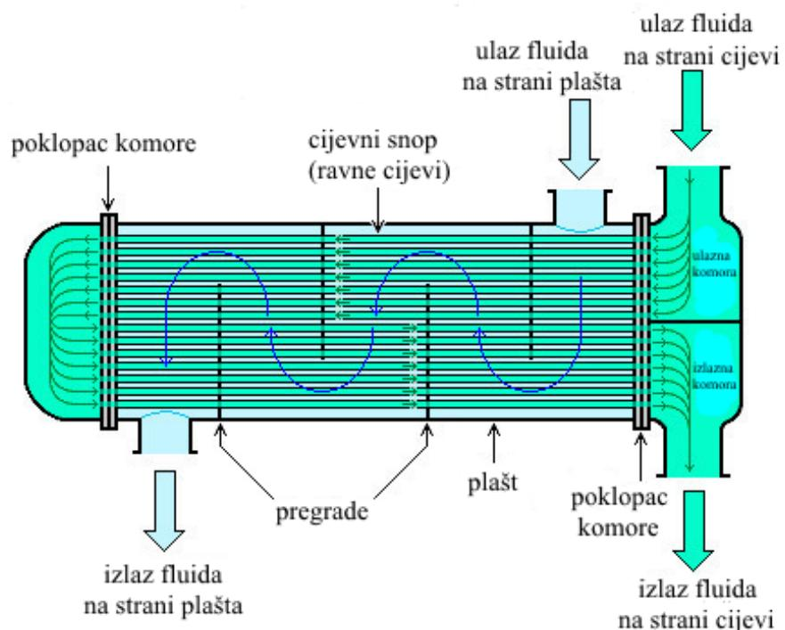
Slika 6. Višecijevni izmjenjivač s učvršćenim snopom cijevi s dva prolaza fluida kroz cijevi i jednim prolazom fluida kroz plašt<sup>6</sup>
