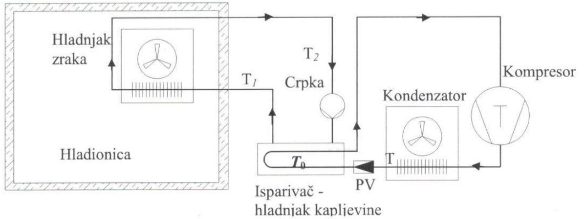
Slika 21. Shematski prikaz rashladnog uređaja s posrednim hlađenjem hladionice putem medija za prijenos topline<sup>9</sup>
