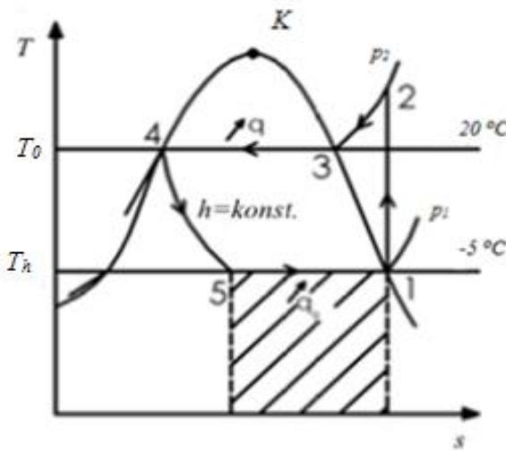
Slika 26. Prikaz kružnog procesa parnog kompresijskog rashladnog uređaja sa suhim usisavanjem, u  $T,s$  dijagramu
