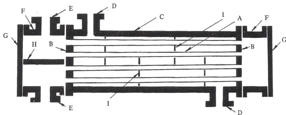
Slika 7. Shematski prikaz izmjenjivača topline s osnovnim dijelovima<sup>7</sup>
