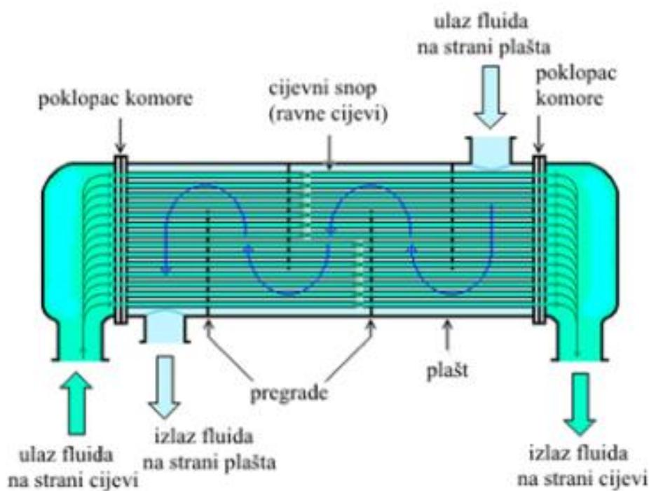
Slika 5. Višecijevni izmjenjivač s učvršćenim snopom cijevi s jednim prolazom fluida kroz cijevi i jednim prolazom fluida kroz plašt<sup>6</sup>
