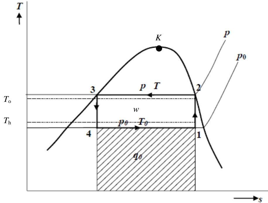
Slika 16. Lijevokretni Carnotov kružni proces u području mokre pare<sup>9</sup>
