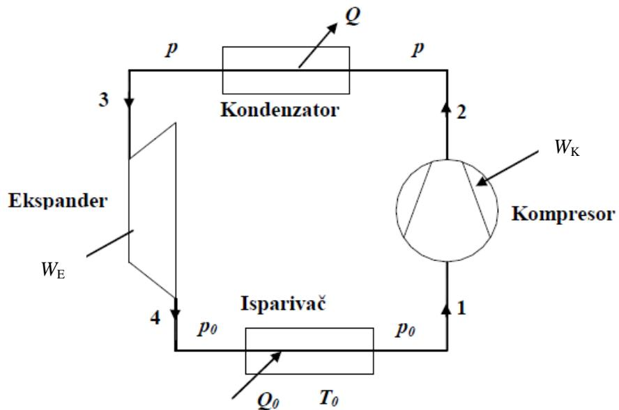
Slika15. Shematski prikaz jednostupanjskog parnog rashladnog uređaja koji radi u području mokre pare po Carnotovom procesu<sup>9</sup>
