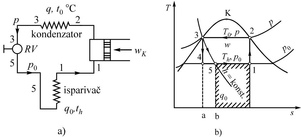
Slika 18. Shema parnog stroja s redukcijskim ventilom (a)
