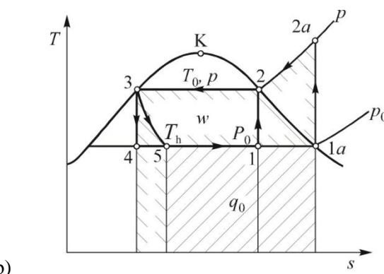
Slika 19. Shema parnog rashladnog stroja s usisavanjem suhozasićene pare (a) i prikaz u  $T,s$  dijagramu (b)<sup>10</sup>
