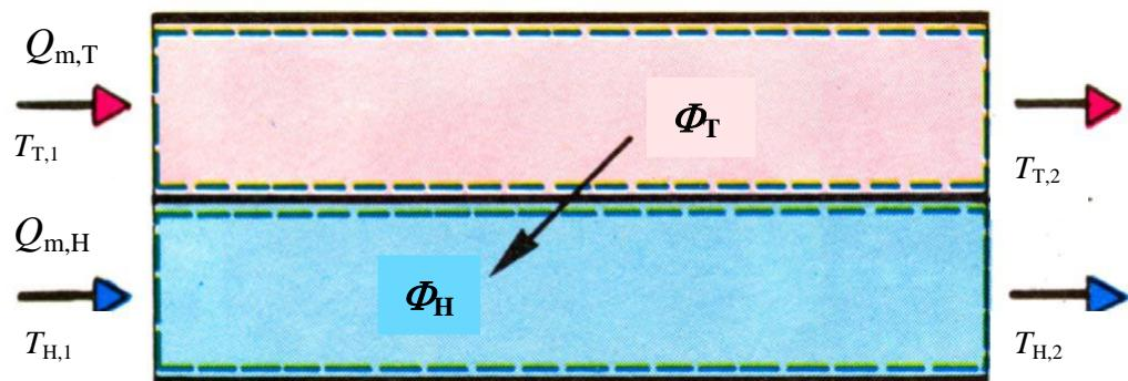
Slika 9. Shematski prikaz bilance energije između topnjeg i hladnjeg fluida u istosmjernom izmjenjivaču topline<sup>2</sup>
