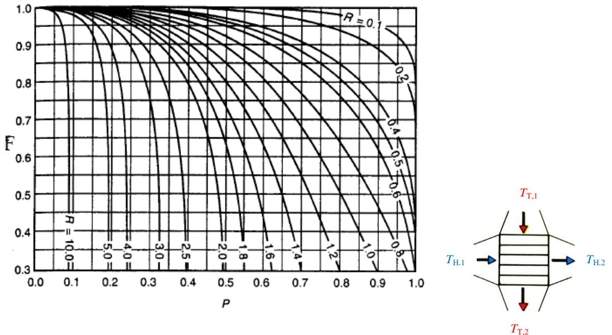
Slika 13. Dijagram ovisnosti  $F = f(P, R)$  za izmjenjivač topline s poprečnim strujanjem<sup>2</sup>
