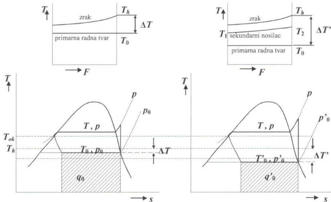
Slika 22. Usporedba procesa s neposrednim isparivanjem i procesa s medijem za prijenos topline u  $T,s$  dijagramu<sup>9</sup>
