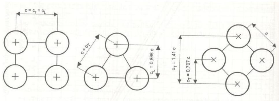
Slika 8. Raspored i korak cijevi u cijevnom snopu<sup>4</sup>
