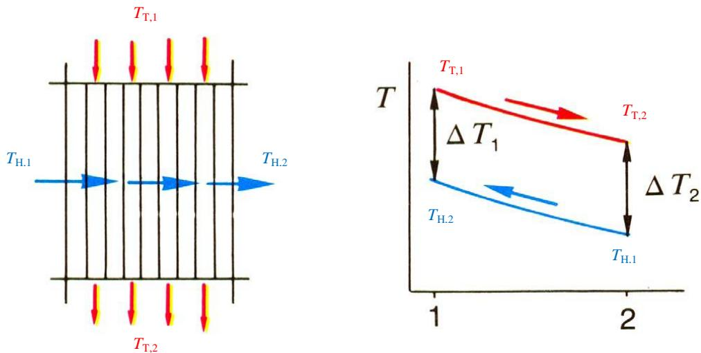
Slika 12. Shematski prikaz križnog izmjenjivača topline (poprečno strujanje fluida) i skica temperaturnog toka struja duž križnog izmjenjivača<sup>2</sup>
