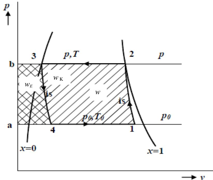
Slika 17. Prikaz  $p,v$  dijagrama Carnotovog lijevokretnog procesa u području zasićene pare<sup>9</sup>
