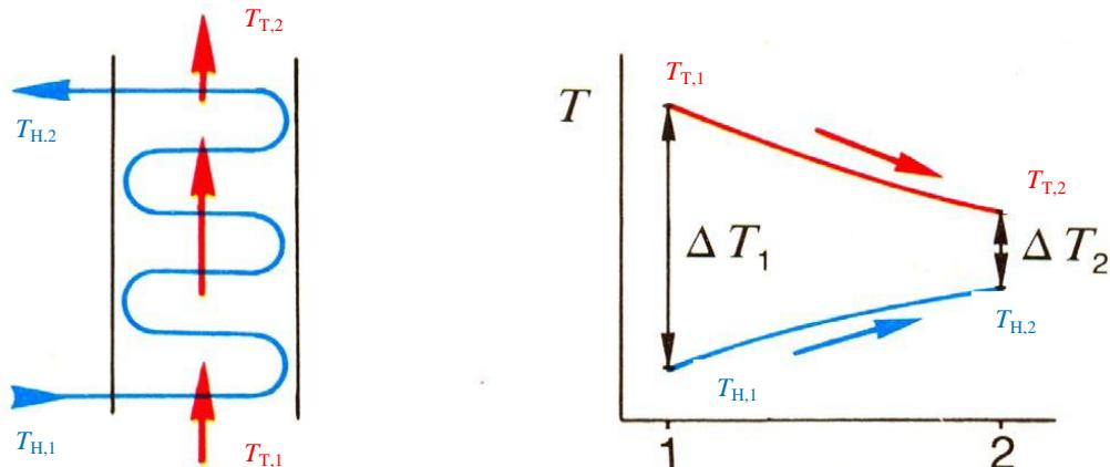
Slika 10. Shematski prikaz istosmjernog izmjenjivača topline i skica temperaturnog toka struja duž istosmjernog izmjenjivača<sup>2</sup>
