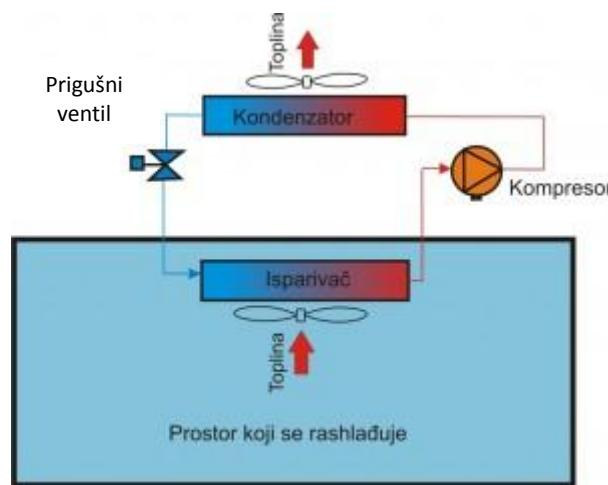
Slika 20. Shema jednostavnog parnog rashladnog postrojenja<sup>12</sup>
