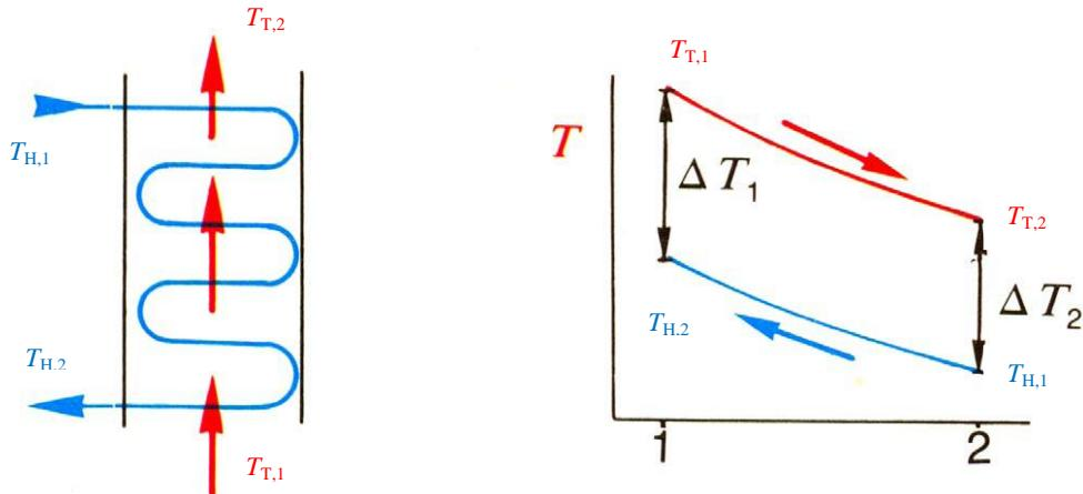
Slika 11. Shematski prikaz protusmjernog izmjenjivača topline i skica temperaturnog toka struja duž protusmjernog izmjenjivača<sup>2</sup>
