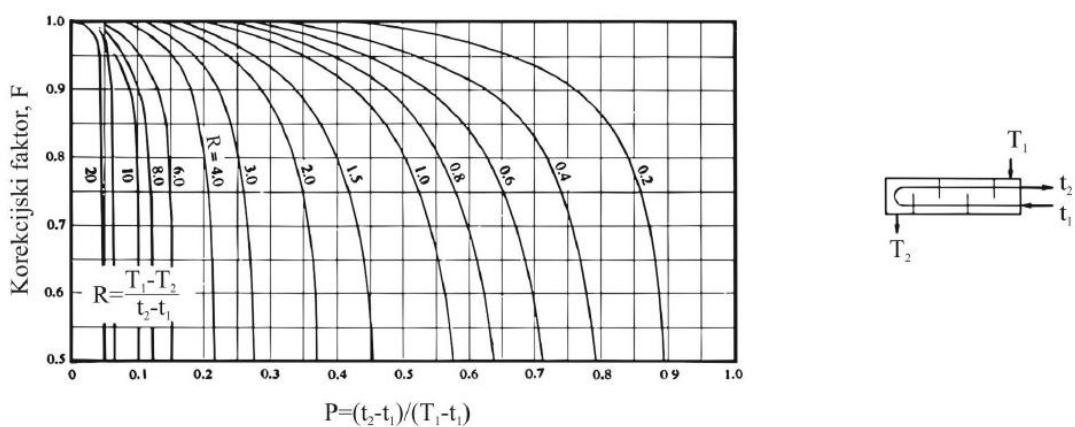
Slika 14. Dijagram ovisnosti<sup>4</sup>  $F = f(P, R)$  za protusmjerni izmjenjivač topline tip 1-2
