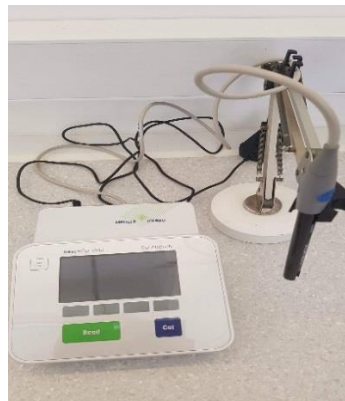
Slika 3. Konduktometar s elektrodom
