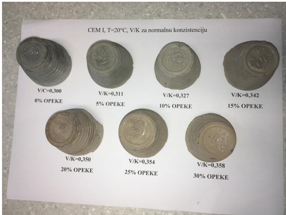
Slika 6. Uzorci cementnih pasti uz dodatak 0-30 mas.% otpadne građevinske opeke nakon određivanja specifične električne provodnosti.
