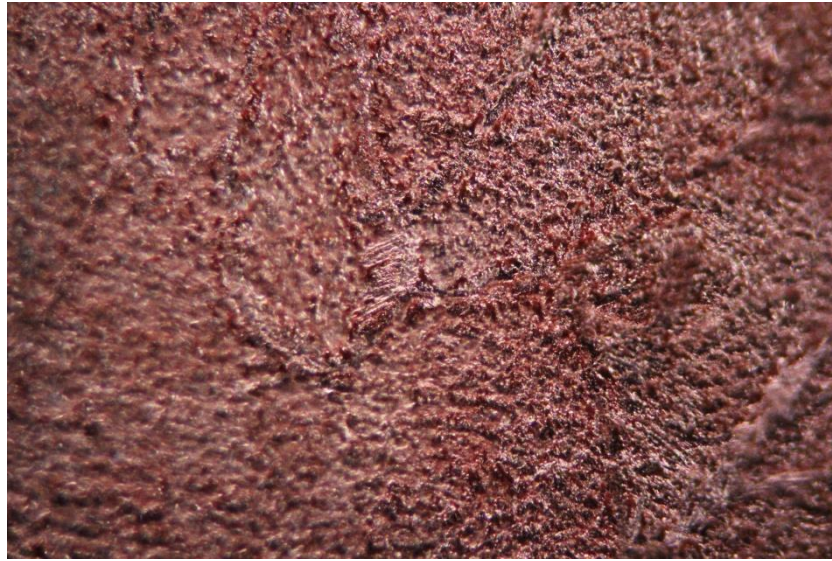
Slika 19. Snimke površine CuAlMn elektrode nakon polarizacijskih mjerenja u 0,5 % NaCl otopini, T = 37\text{ }^{\circ}\text{C} , \text{pH} = 7,4 , uz povećanje 200 puta.
