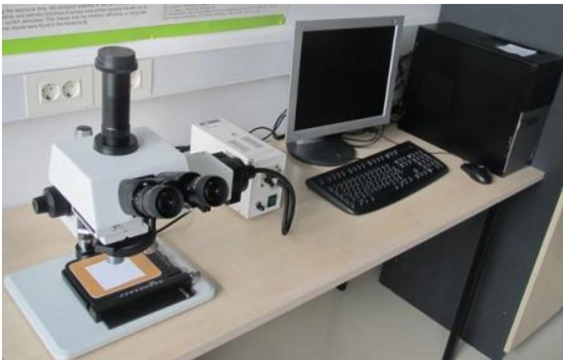
**Slika 18.** Optički mikroskop
