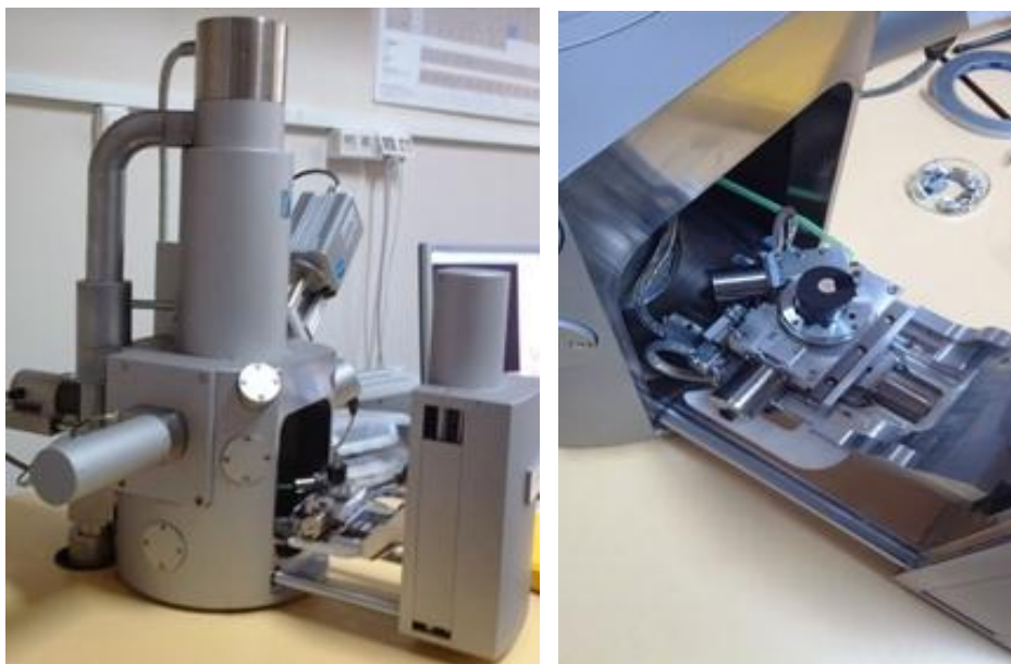
Slika 19. Pretražni elektronski mikroskop Tescan Vega TS5136LS
