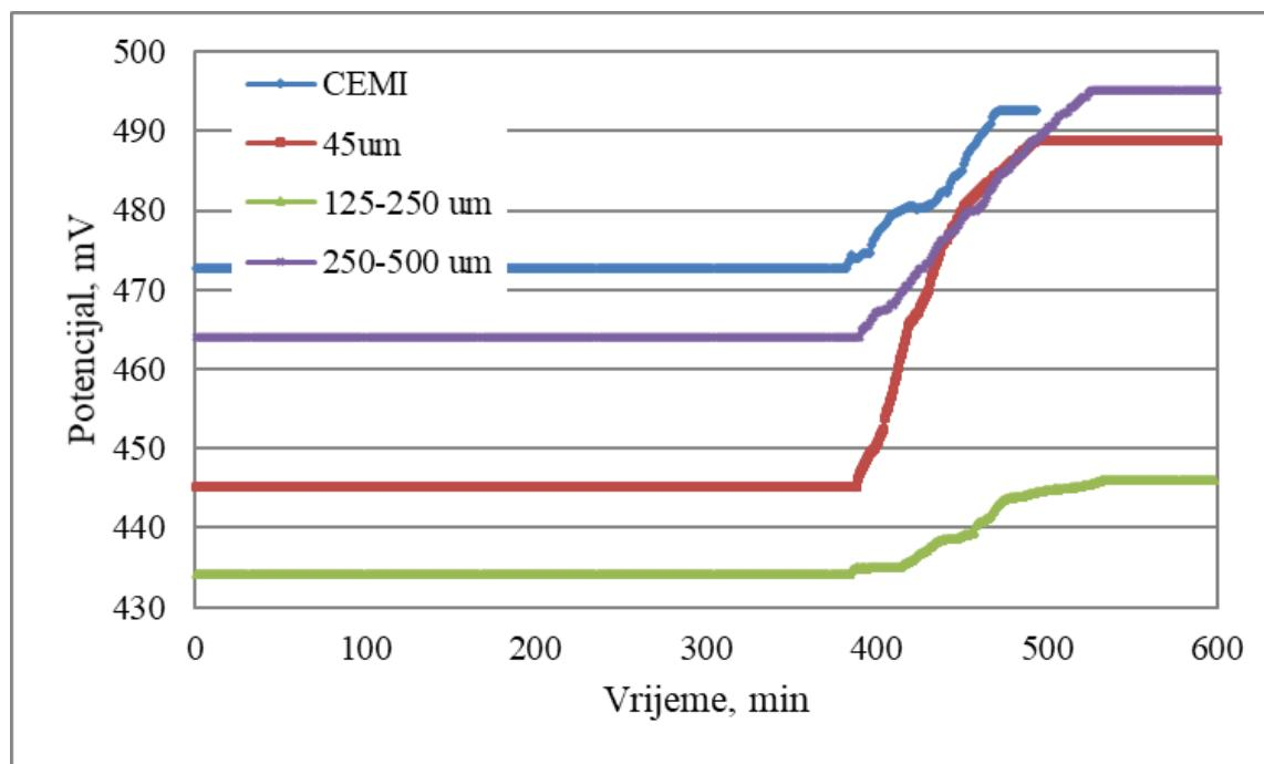
**Slika 9.** Zajednički prikaz ovisnosti promjene elektrodnog potencijala o vremenu hidratacije za cement tipa CEM I bez i s dodatkom 20 mas.% različitih frakcija otpadnog ambalažnog stakla pri  $V/K$  ili  $V/C=0,5$ .
