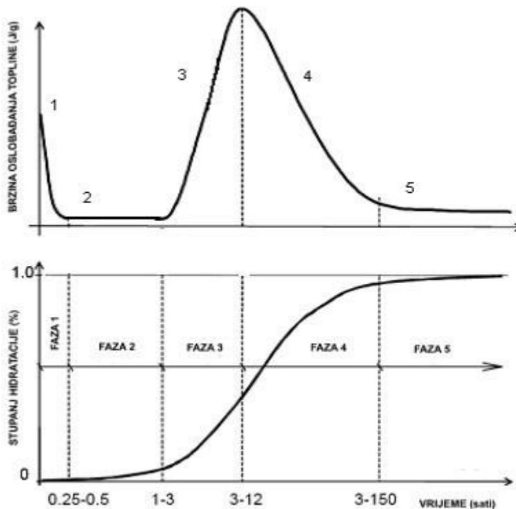
**Slika 4.** Ovisnost topline hidratacije i stupnja hidratacije o vremenu hidratacije<sup>15</sup>.
