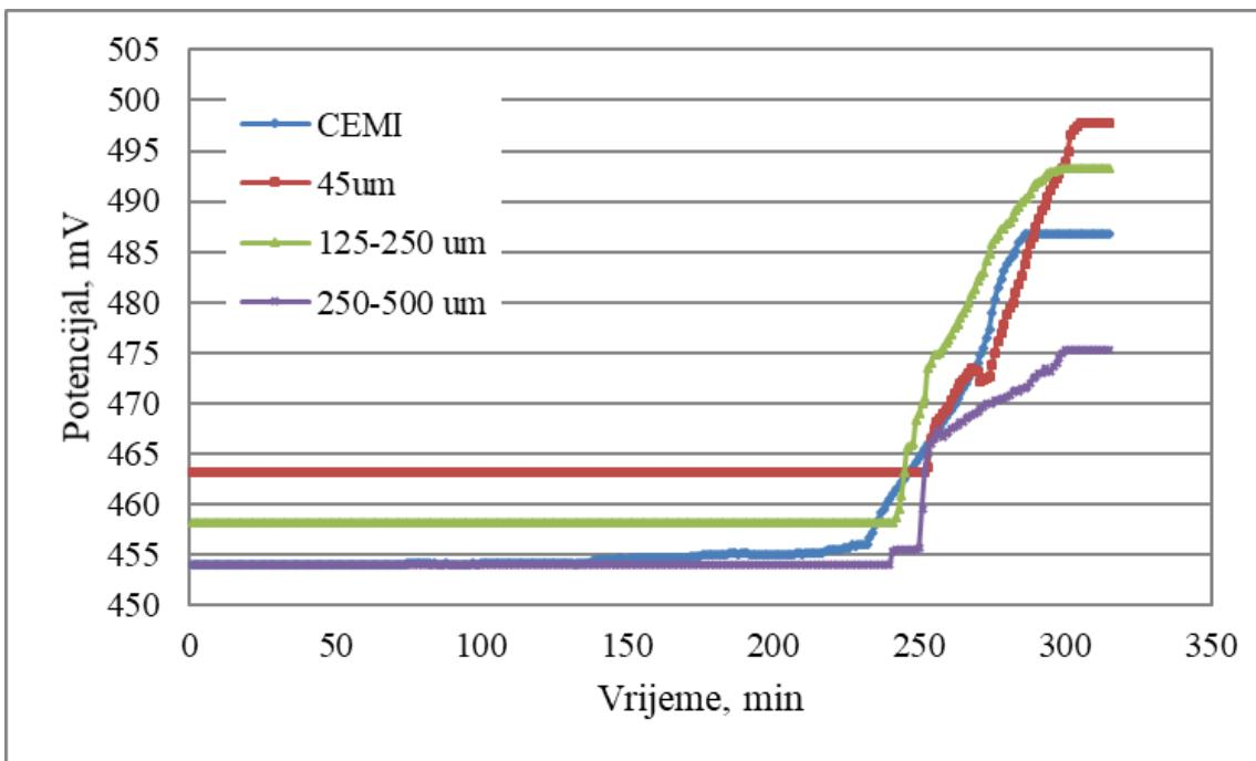
**Slika 10.** Zajednički prikaz ovisnosti promjene elektrodnog potencijala o vremenu hidratacije za cement tipa CEM I bez i s dodatkom 20 mas.% različitih frakcija otpadnog ambalažnog stakla pri normalnoj konzistenciji.
