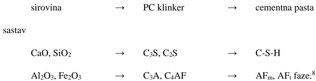
Ova shema ujedno i prikazuje osnovni oksidni sastav sirovinske smjese za proizvodnju portland cementnog klinkera.
