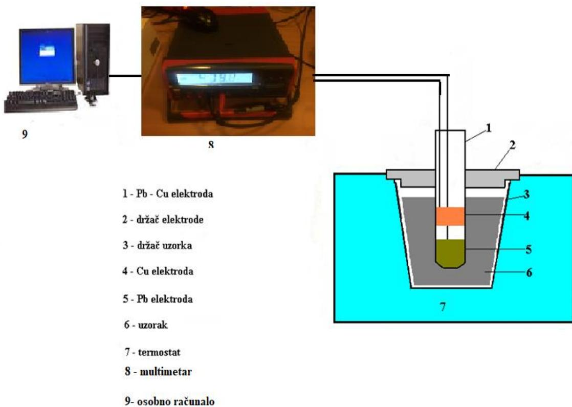
**Slika 8.** Shema aparature za određivanje vremena vezivanja elektrokemijskom metodom s Pb-Cu elektrodnim parom.
