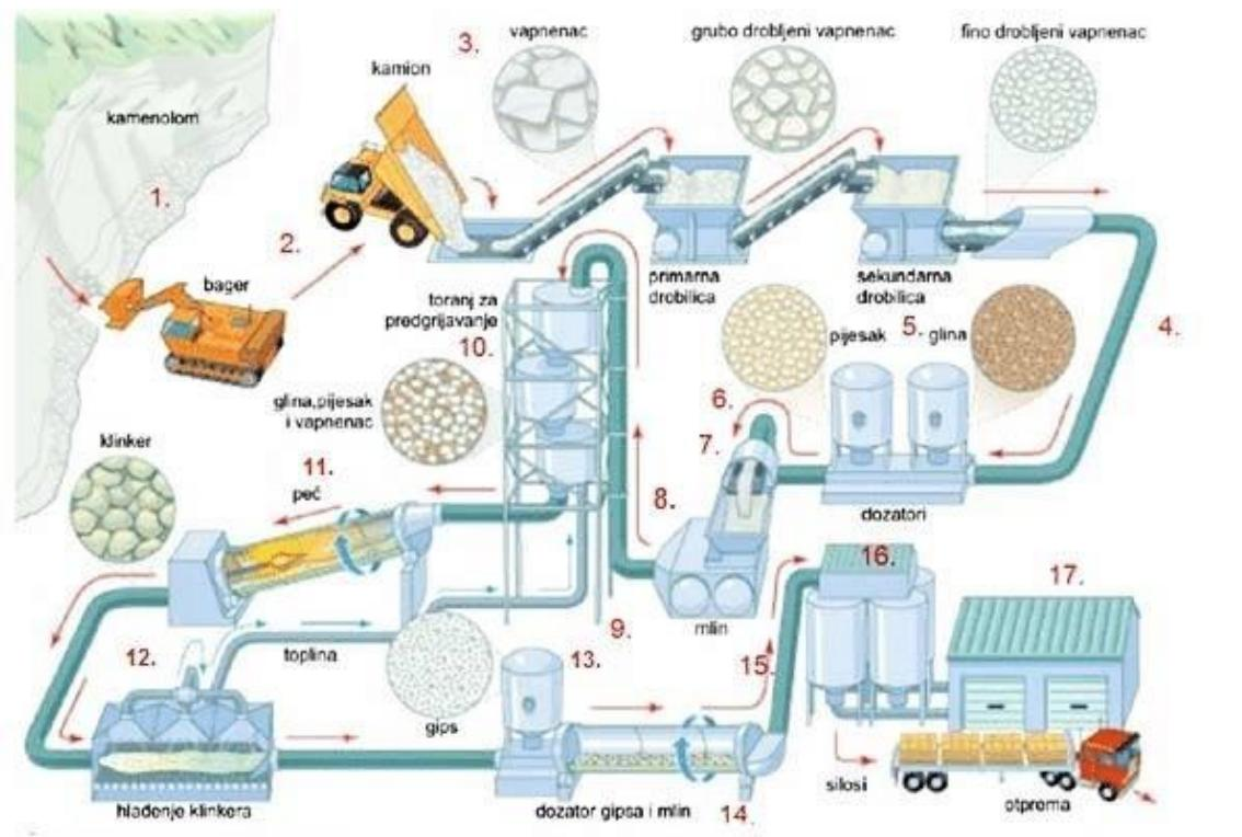
Slika 3. Shema tehnološkog procesa proizvodnje portland cementa.<sup>10</sup>
