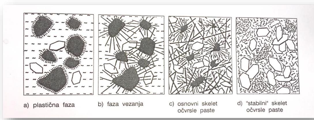
**Slika 6.** Shematski prikaz formiranja strukture očvrsle cementne paste.<sup>8</sup>
