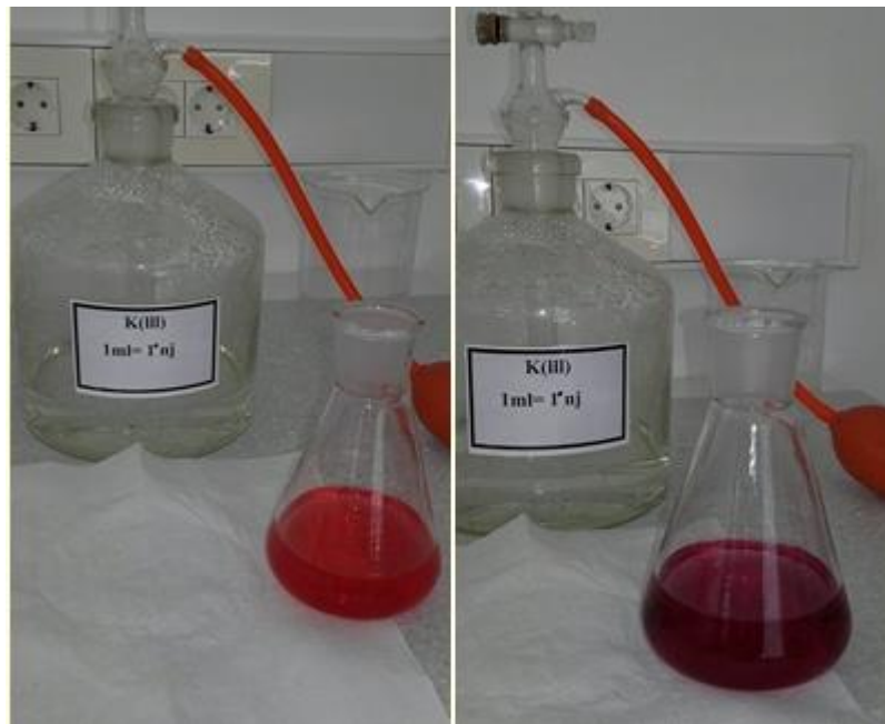
Slika 10. Promjena boje tijekom titracije s EDTA iz purpurne u ljubičastu
