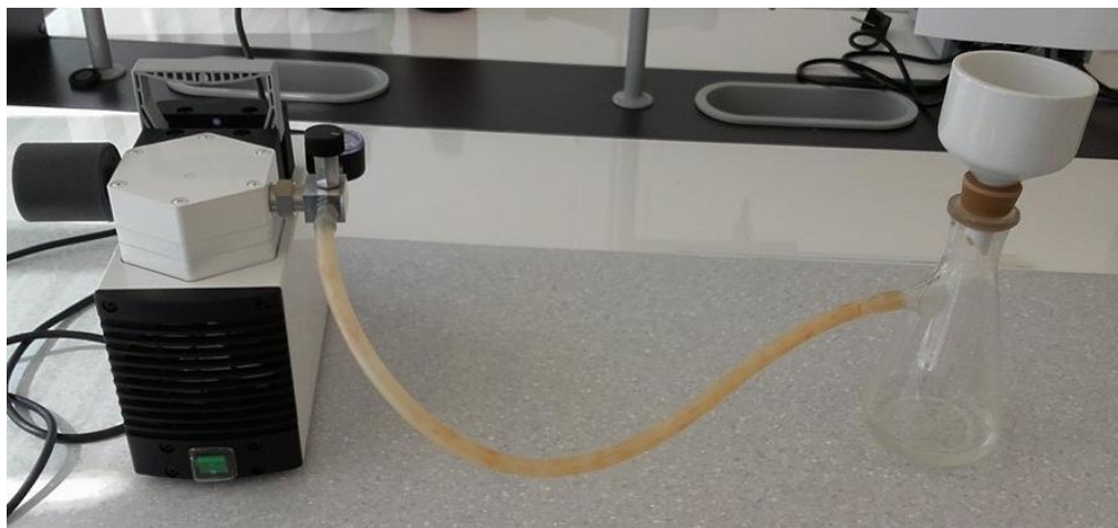
Slika 8. Aparatura za filtraciju kroz Büchnerov lijevak
