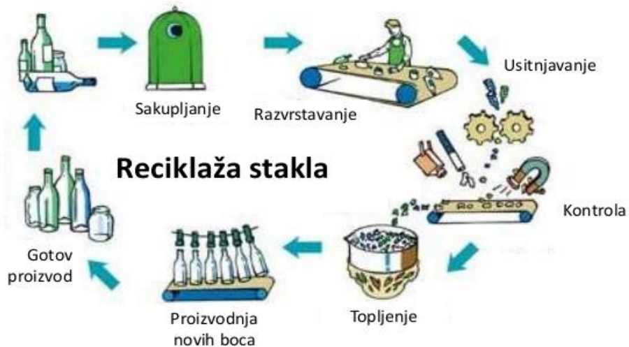
Slika 1. Shematski prikaz procesa reciklaže stakla 5
