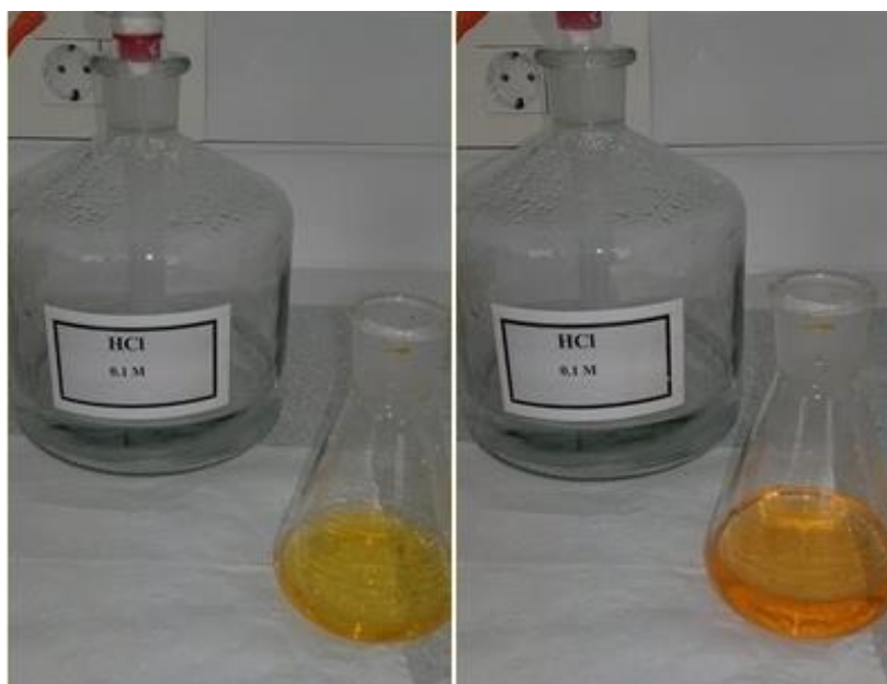
Slika 9. Promjena boje tijekom titracije s HCl iz žute u narančastu
