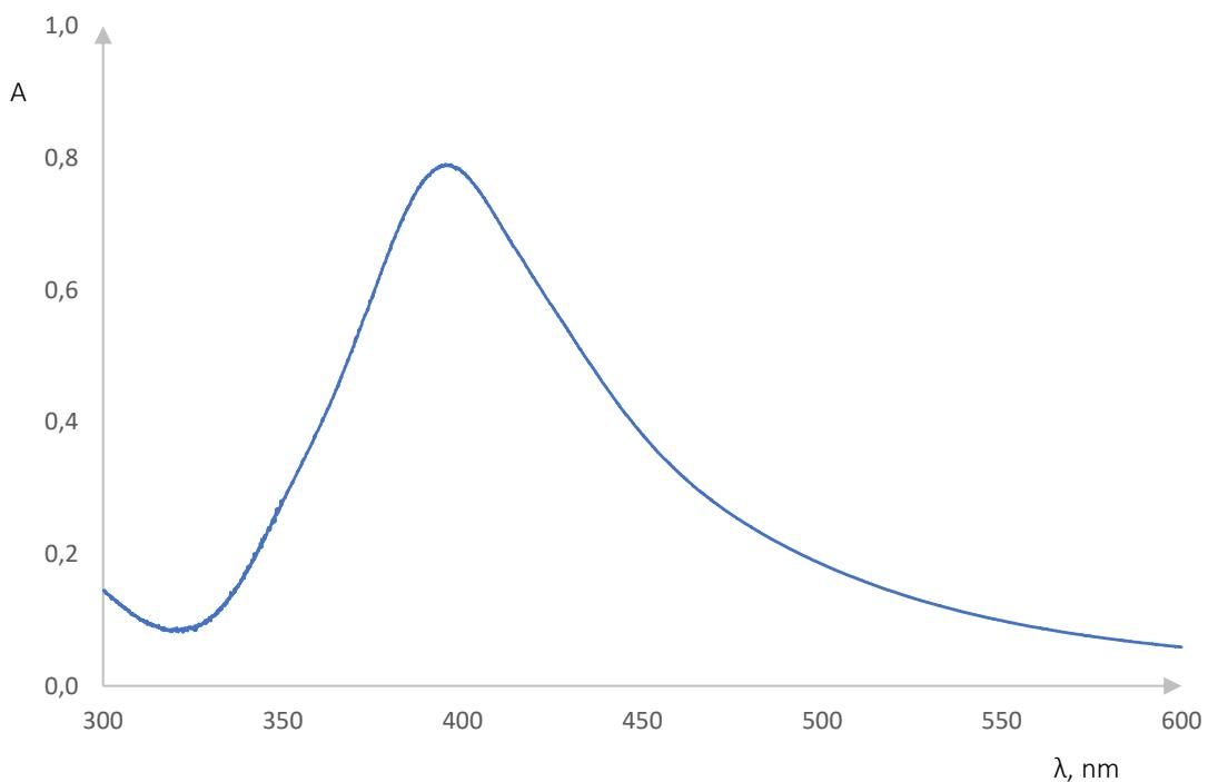
Slika 25. Apsorpcijski spektar pri koncentraciji  $\text{AgNO}_3 0,0015 \text{ mol/dm}^3$
