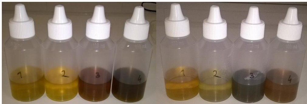
Slika 7. Otopine koloidnog srebra pripremljene destiliranom vodom s \text{pH} = 7,38 poredanih s lijeva na desno počevši s najnižom koncentracijom. Slika desno prikazuje stanje boja otopina nakon 14 dana.
