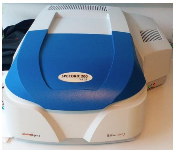
Slika 6. Analytik Jena SPECORD® 200 Plus Edition 2010 UV/Vis spektrofotometar
