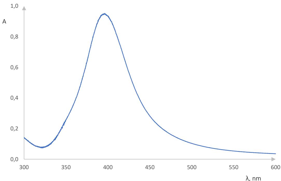
Slika 37. Apsorpcijski spektar pri koncentraciji  $\text{AgNO}_3 0,0020 \text{ mol/dm}^3$
