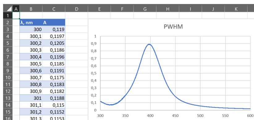
Na temelju dobivene krivulje u ćeliji *D3* se izračuna minimum apsorbancije  $=\text{MIN}(\text{C}\$3:\text{C}\$503)$ . U ovom primjeru riječ je o rasponu valnih duljina 300-350 nm. Cijeli stupac će se automatski popuniti i na grafikonu će se iscrtati pravac. Stupac se nazove *MIN*.
