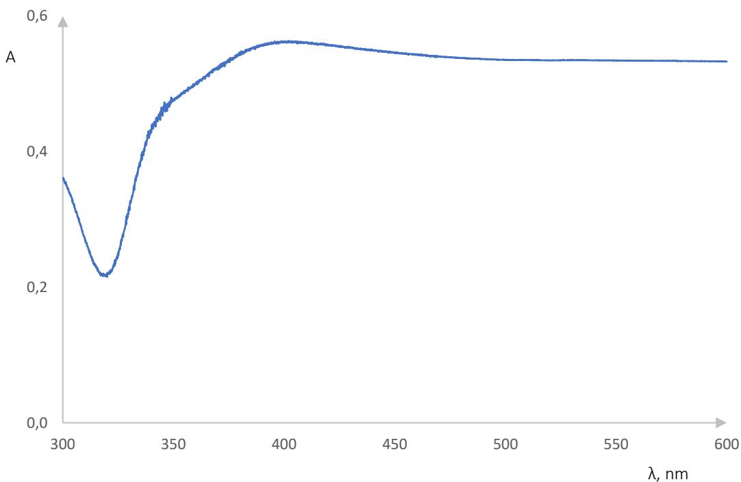
Slika 29. Apsorpcijski spektar pri koncentraciji  $\text{AgNO}_3 0,0015 \text{ mol/dm}^3$
