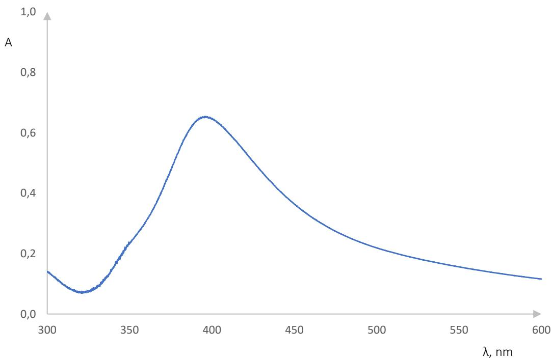
Slika 31. Apsorpcijski spektar pri koncentraciji  $\text{AgNO}_3 0,0010 \text{ mol/dm}^3$
