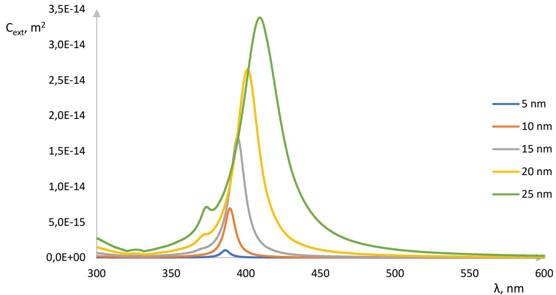
Dobivenu tekstualnu datoteku potrebno je otvoriti u Microsoft Excelu. Iz tabličnih vrijednosti za  $C_{ext}$  potrebno je pronaći maksimum i njemu pripadajuću valnu duljinu. Iz tih valnih duljina dobivenih i promjera čestica potrebno je izraditi raspršeni grafikon i nacrtati crtlu trenda.
