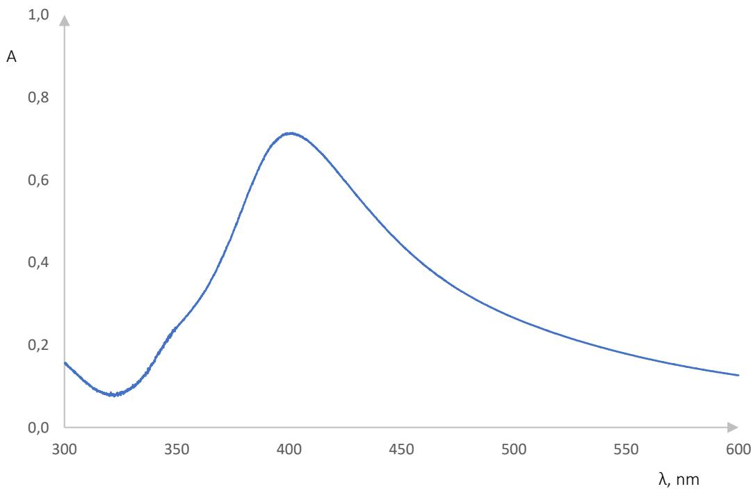
Slika 32. Apsorpcijski spektar pri koncentraciji  $\text{AgNO}_3 0,0015 \text{ mol/dm}^3$
