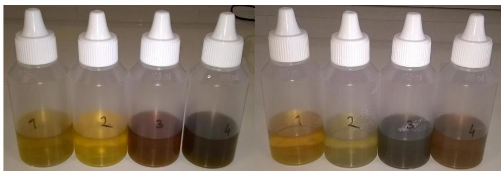
Slika 7. Otopine koloidnog srebra pripremljene destiliranim vodom s  $\text{pH} = 7,38$  poredanih s lijeva na desno počevši s najnižom koncentracijom. Slika desno prikazuje stanje boja otopina nakon 14 dana.
