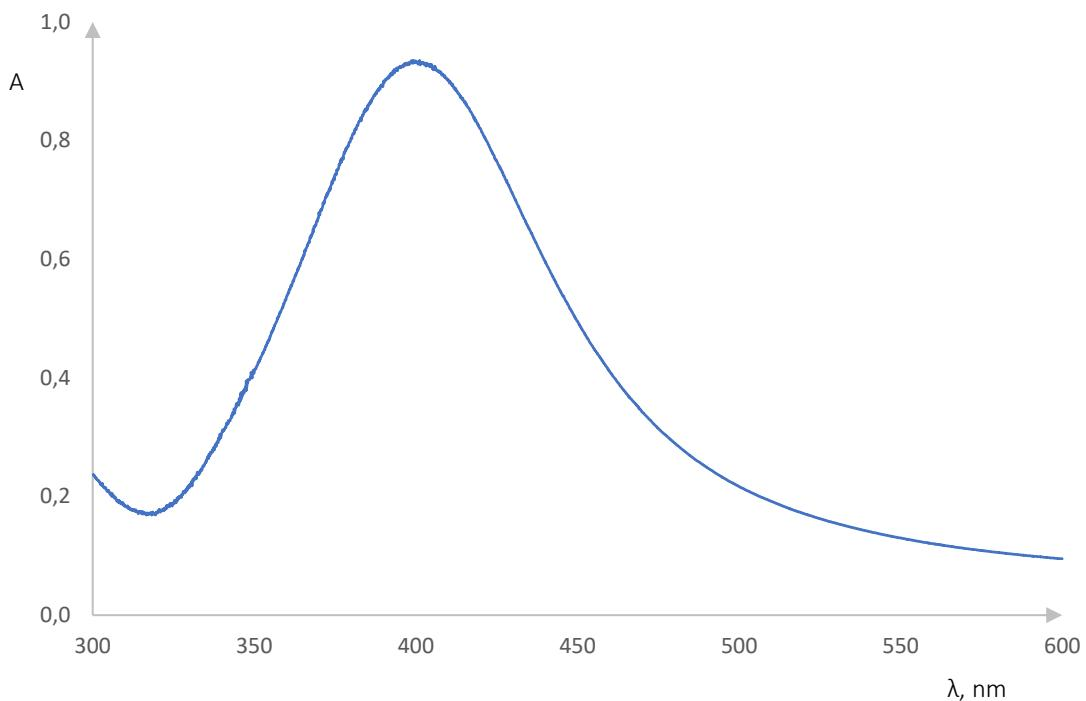
Slika 23. Apsorpcijski spektar pri koncentraciji  $\text{AgNO}_3$  0,0005 mol/dm<sup>3</sup>
