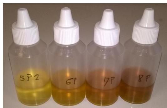
Slika 10. Otopine koloidnog srebra pripremljene demineraliziranim vodom s  $pH = 6,08$  poredanih s lijeva na desno počevši s najnižom koncentracijom.
