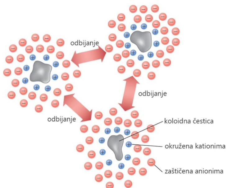
Slika 1. Grafički prikaz stabilizacije koloida s anionima i kationima<sup>12</sup>
