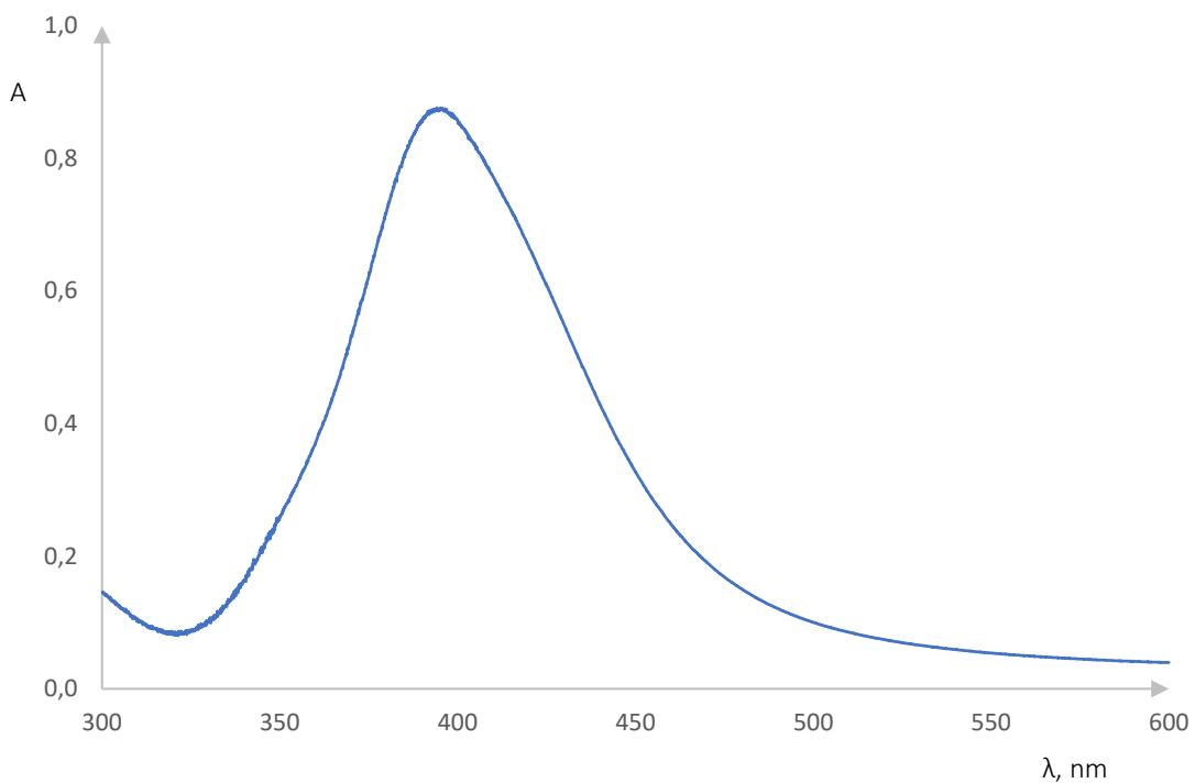
Slika 35. Apsorpcijski spektar pri koncentraciji  $\text{AgNO}_3 0,0010 \text{ mol}/\text{dm}^3$
