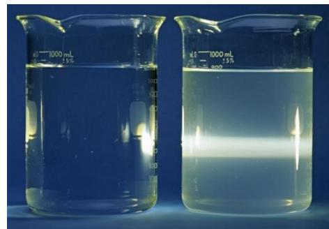
Slika 3. Usporedba raspršenja zrake svjetlosti na koloidnoj (desno) i pravoj otopini<sup>14</sup>
