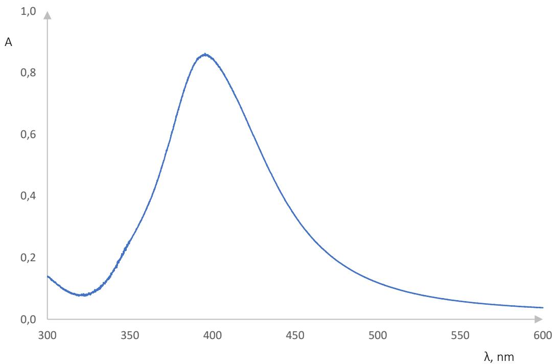
Slika 36. Apsorpcijski spektar pri koncentraciji  $\text{AgNO}_3 0,0015 \text{ mol}/\text{dm}^3$
