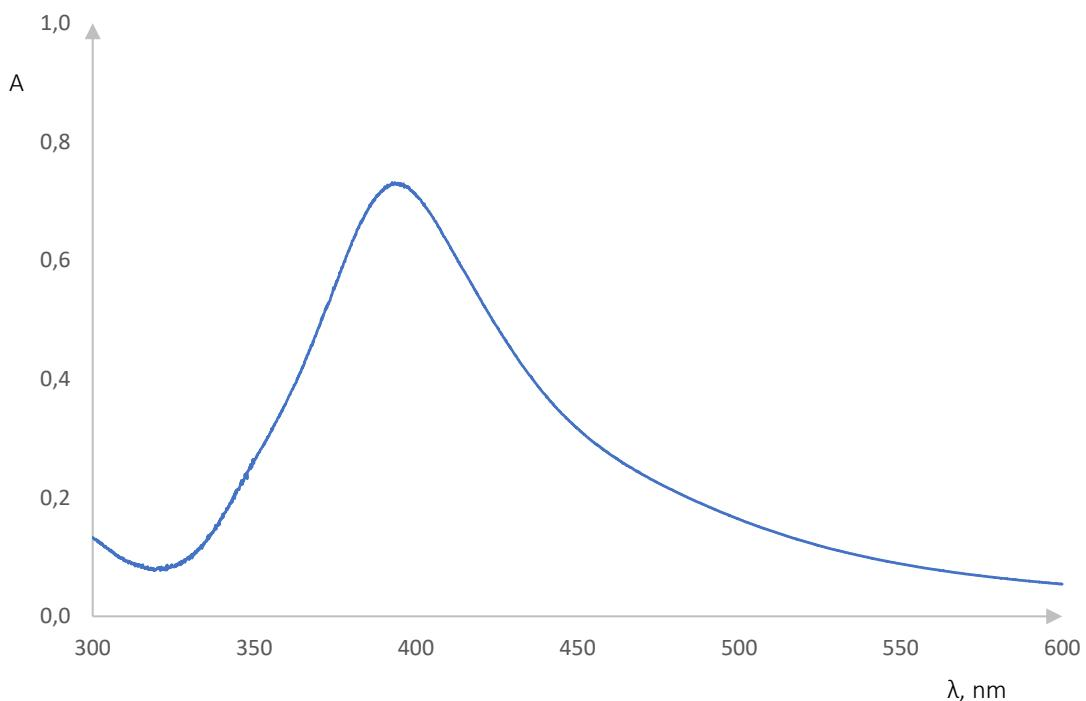
Slika 26. Apsorpcijski spektar pri koncentraciji  $\text{AgNO}_3 0,0020 \text{ mol/dm}^3$
