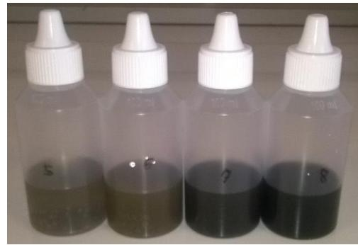
Slika 8. Otopine koloidnog srebra pripremljene destiliranim vodom poredanih s lijeva na desno počevši s najnižom koncentracijom.
