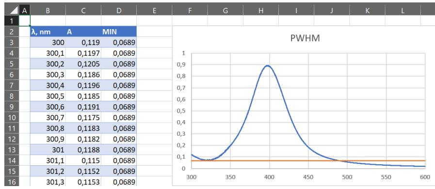
U ćeliji *I4* se izračuna maksimum apsorbancije  $=\text{MAX}(\text{Tablica1}[A])$
