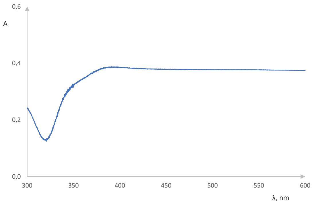
Slika 28. Apsorpcijski spektar pri koncentraciji  $\text{AgNO}_3$   $0,0010 \text{ mol}/\text{dm}^3$
