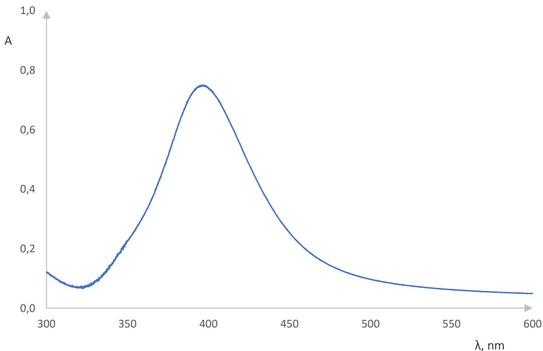
Slika 34. Apsorpcijski spektar pri koncentraciji  $\text{AgNO}_3 0,0005 \text{ mol/dm}^3$
