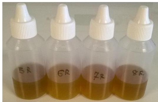
Slika 9. Otopine koloidnog srebra pripremljene demineraliziranim vodom s  $pH = 7,05$  poredanih s lijeva na desno počevši s najnižom koncentracijom.
