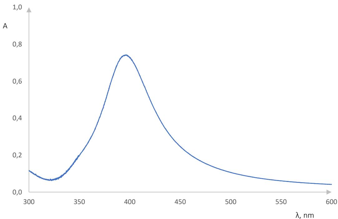
Slika 33. Apsorpcijski spektar pri koncentraciji  $\text{AgNO}_3 0,0020 \text{ mol/dm}^3$
