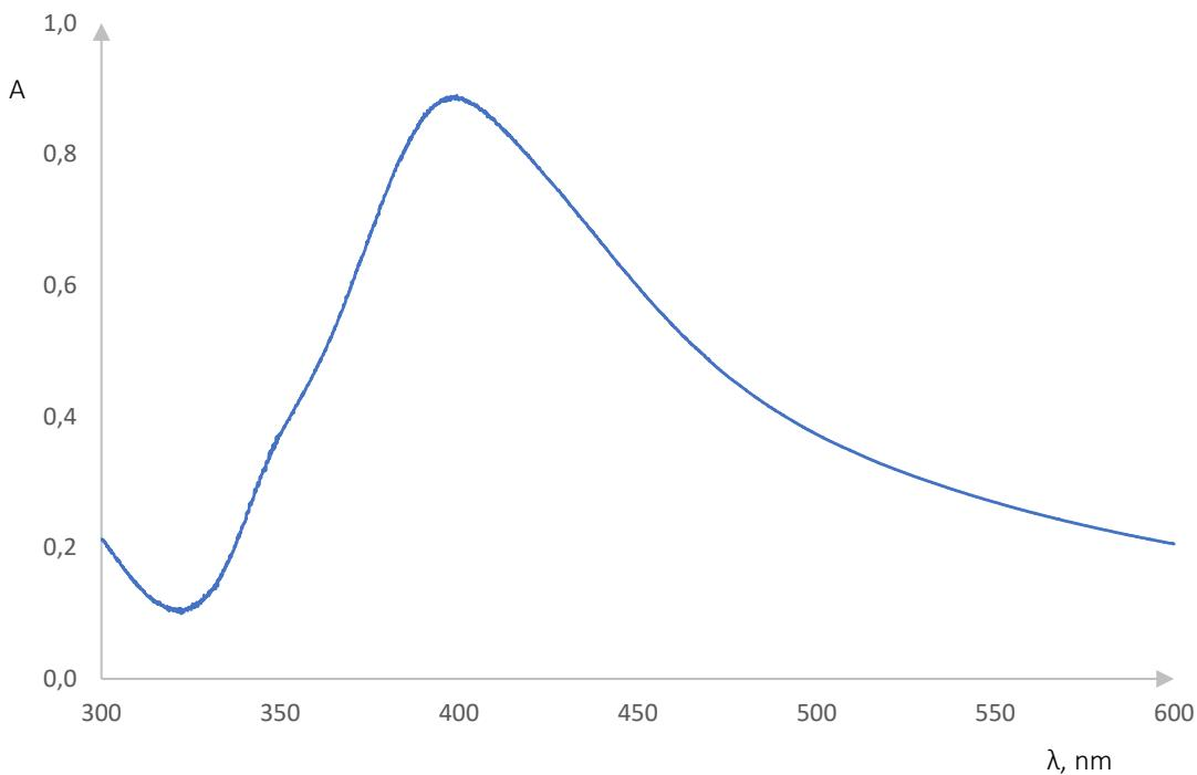
Slika 30. Apsorpcijski spektar pri koncentraciji  $\text{AgNO}_3 0,0005 \text{ mol/dm}^3$
