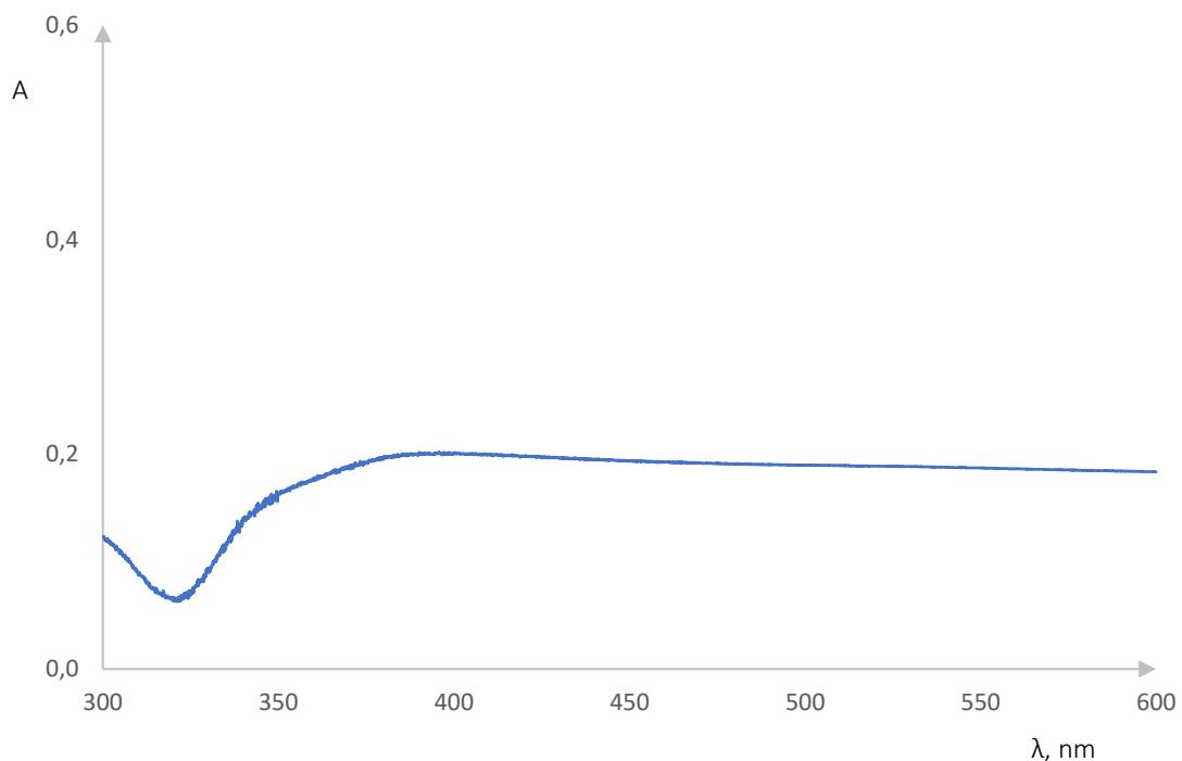
Slika 27. Apsorpcijski spektar pri koncentraciji  $\text{AgNO}_3$   $0,0005 \text{ mol}/\text{dm}^3$
