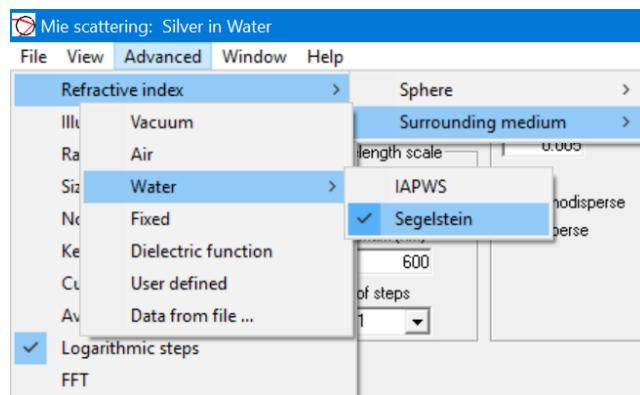
Zatim je potrebno definirati vrstu grafa koji se dobiti i to tako da se u padajućem izborniku odabere *Cext/Csca/Cabs v. wavelength*. Skala valnih duljina se stavlja unutar granica s kojima se mjerila UV/Vis apsorbancija. Broj koraka se može ostaviti na 1000 ili se upiše broj točaka koliko je puta izmjerena apsorbancija. Što je veći broj koraka to je rezultat precizniji. Kao radijus čestice se uzima 0.005  $\mu\text{m}$  (brojevi se upisuju s decimalnom točkom).
