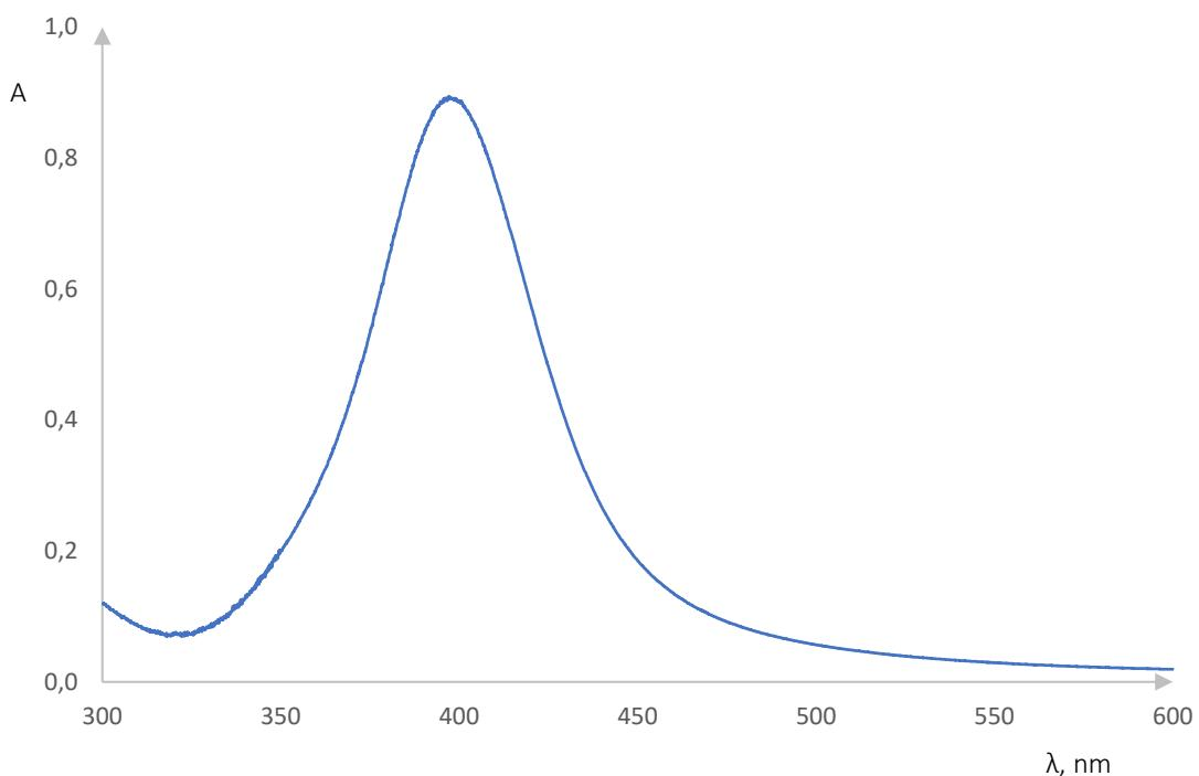
Slika 24. Apsorpcijski spektar pri koncentraciji  $\text{AgNO}_3$  0,0010 mol/dm<sup>3</sup>
