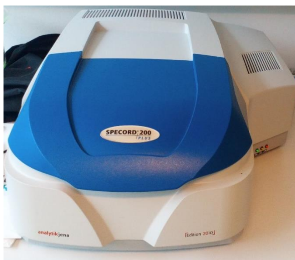
Slika 6. Analytik Jena SPECORD® 200 Plus Edition 2010 UV/Vis spektrofotometar
