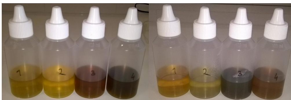
Slika 7. Otopine koloidnog srebra pripremljene destiliranom vodom s \text{pH} = 7,38 poredanih s lijeva na desno počevši s najnižom koncentracijom. Slika desno prikazuje stanje boja otopina nakon 14 dana.
