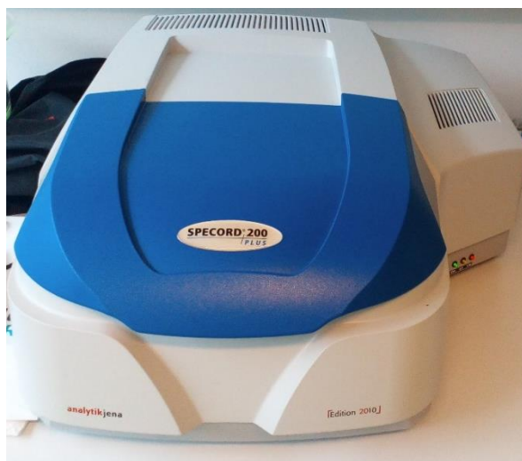
Slika 6. Analytik Jena SPECORD® 200 Plus Edition 2010 UV/Vis spektrofotometar
