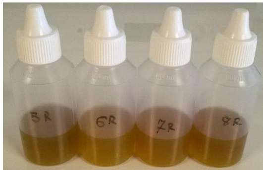
Slika 9. Otopine koloidnog srebra pripremljene demineraliziranom vodom s pH = 7,05 poredanih s lijeva na desno počevši s najnižom koncentracijom.
