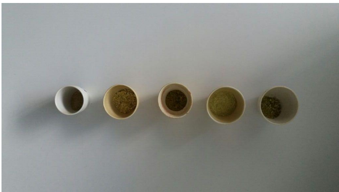
Slika 2.7. Uzorci pripremljeni za žarenje u peći na 500°C
