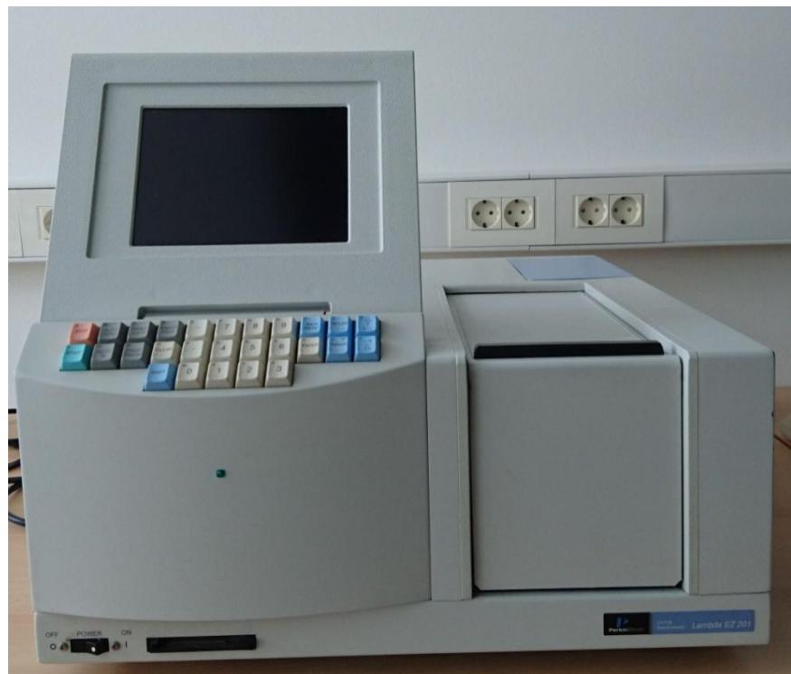
*Slika 2.4 Spektrofotometar Perkin Elmer Lambda EZ 201*
