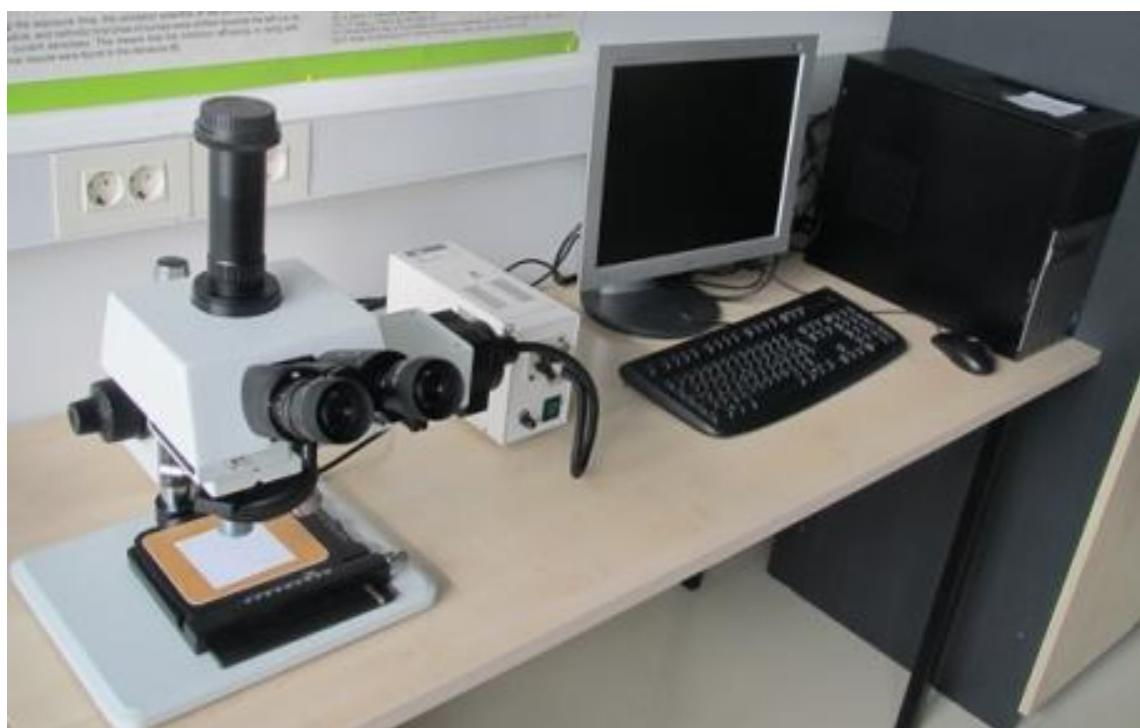
*Slika 2.8 A13.0908-B Metalurški mikroskop sa svjetlim i tamnim poljem*
