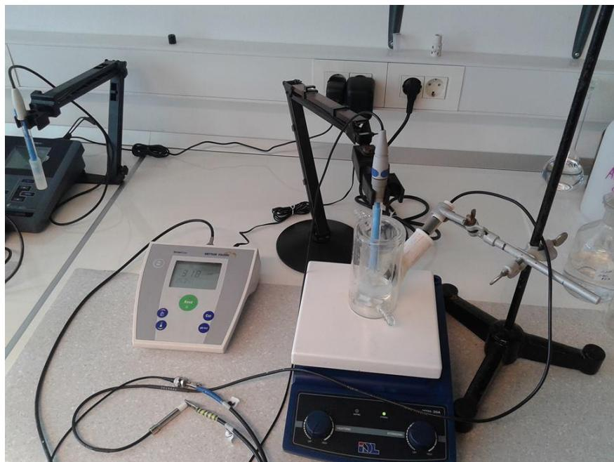
*Slika 2.5 Elektrokemijska ćelija s elektrodama za mjerjenje potencijala*
