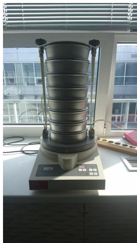
*Slika 2.6 Vibracijska tresilica*
