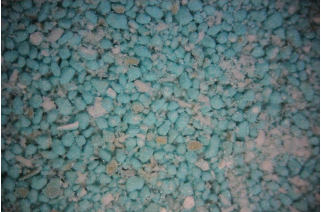
Slika 3.3 Mikroskopski snimak ljuskica jaja nakon sorpcije pri uvećanju 50x
