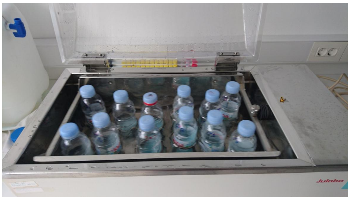
Slika 2.12 Reaktori u tresilici
