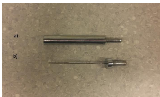
Slika 9. a) valjak Vicatova aparata za određivanje normalne konzistencije cementnih pasti; b) igla Vicat-ova aparata za određivanje početka i kraja vezanja cementnih pasti
