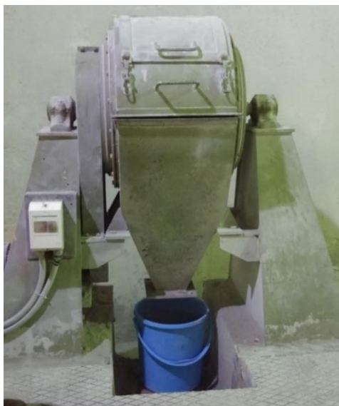
Slika 6. Prikaz poluindustrijskog horizontalnog mlina s čeličnim kuglama [14]
