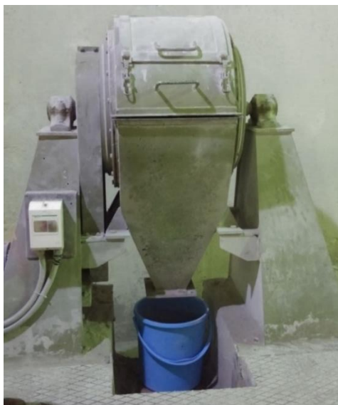
Slika 6. Prikaz poluindustrijskog horizontalnog mlina s čeličnim kuglama [14]
