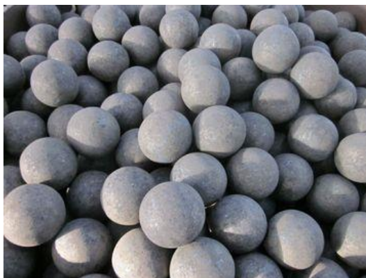
Slika 17. Čelične kugle za punjenje horizontalnog mlina [27]
