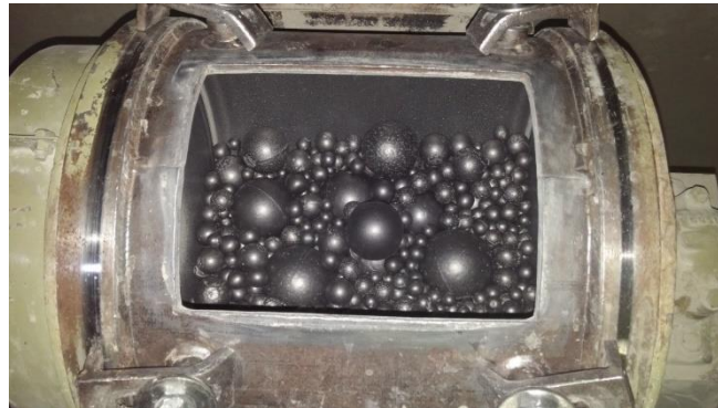
Slika 28. Punjenje poluindustrijskog horizontalnog mlina s čeličnim kuglama
