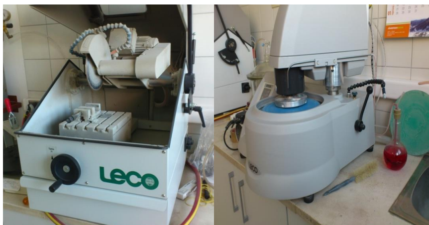
Slika 24. Priprema uzoraka za mikroskopiju a) rezalica materijala b) brusilica/polirka uzoraka
