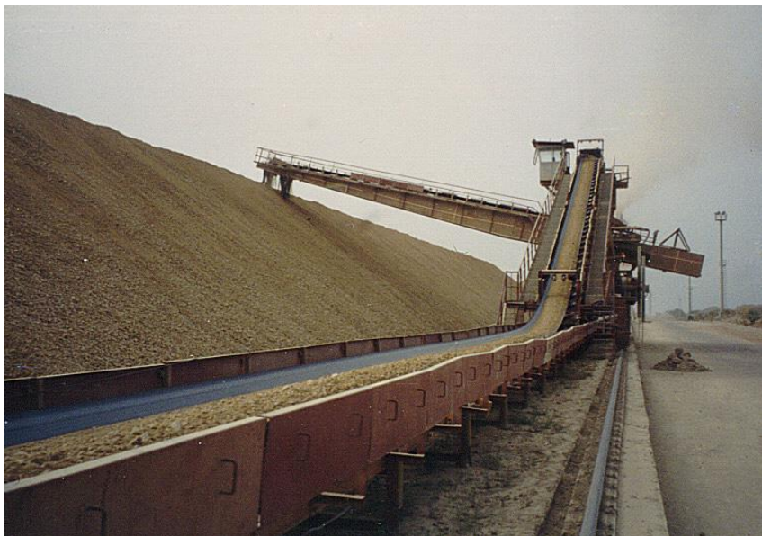
Slika 2. Prikaz mješalice za predhomogenizaciju na deponiju [11]
