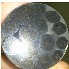
Slika 25. Uzorak klinkera pripravljen za mikroskopiju
