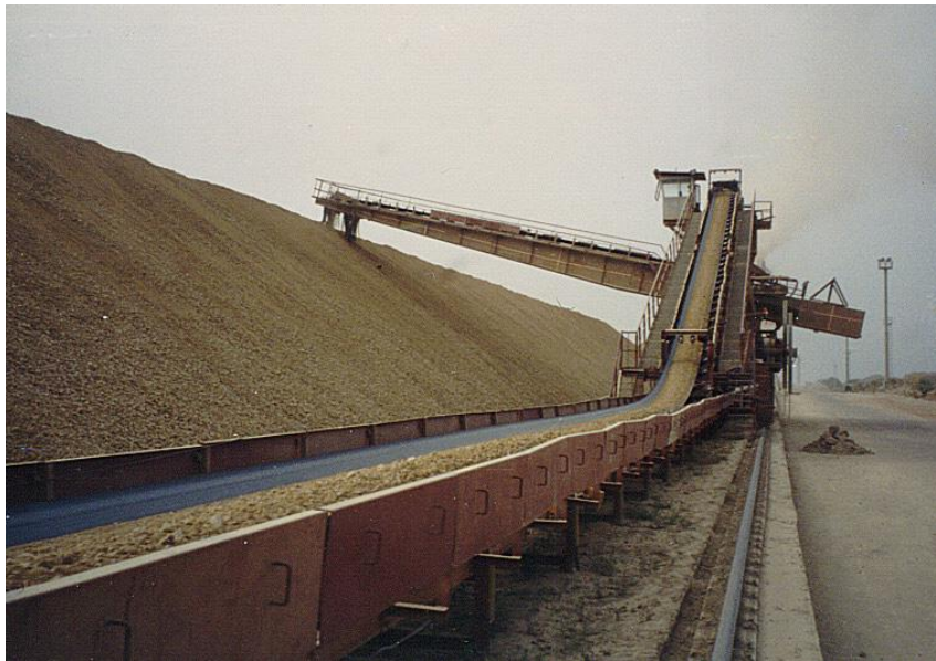
Slika 2. Prikaz mješalice za predhomogenizaciju na deponiju [11]
