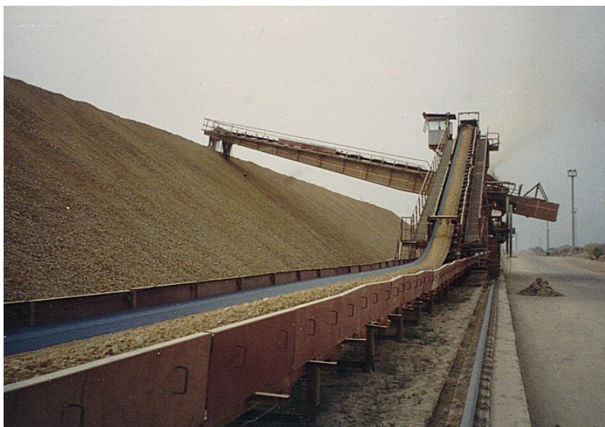
Slika 2. Prikaz mješalice za predhomogenizaciju na deponiju [11]
