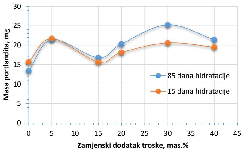
**Slika 20.** Sadržaj portlandita u uzorcima cementnih pasta pripravljenih s dodatkom od 5, 15, 20, 30 i 40 mas.% zamjenskog dodatka troske na masu cementa nakon 15 i 85 dana hidratacije. [14]
