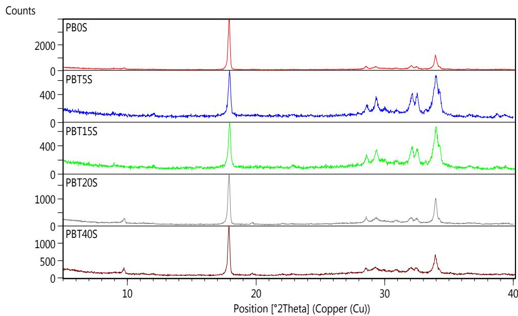
**Slika 17.** Usporedba difrakcijskih slika polikristalnih uzoraka cementnih pasta, nakon 80 dana njegovanja u vodenoj kupelji pri temperaturi od 20 °C (uzorci pripravljeni s V/C=0,5 i dodatak superplastifikatora)
