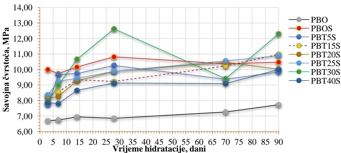
**Slika 15.** Usporedba razvijene savojne čvrstoće u sustavima cementnih mortova pripravljenih korištenjem CEM I 42,5R bez i sa zamjenskim dodatak troske u iznosima od 0, 5, 15, 20, 25, 30 i 40 mas.% bez i sa dodatkom aditiva BASF Glenium ACE 430
