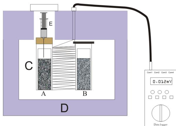
**Slika 7.** Shematski prikaz diferencijalnog mikrokalorimetra (DMK); A-mjerna ćelija, B-referentna ćelija, C-odvojeni termički izolirani prostor u kojem su smještene ćelije A i B, E-injektiranje potrebne vode, D-termostatirana vodena kupelj.
