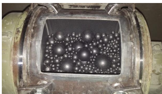
Slika 4. Punjenje poluindustrijskog horizontalnog mlina s čeličnim kuglama [11]
