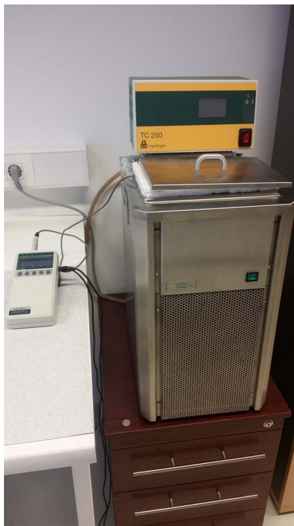
Slika 4. Termostatski uređaj (u kojem se nalazi diferencijalni mikrokalorimetar) te uređaj za registriranje – Data Logger
