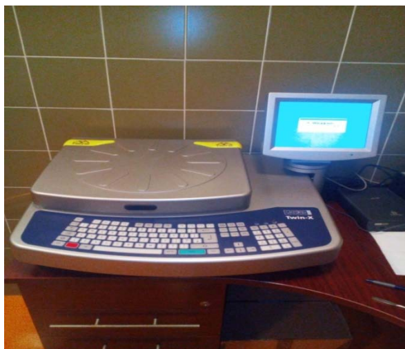
Slika 5. EDXRF uređaj za kvantitativnu analizu
