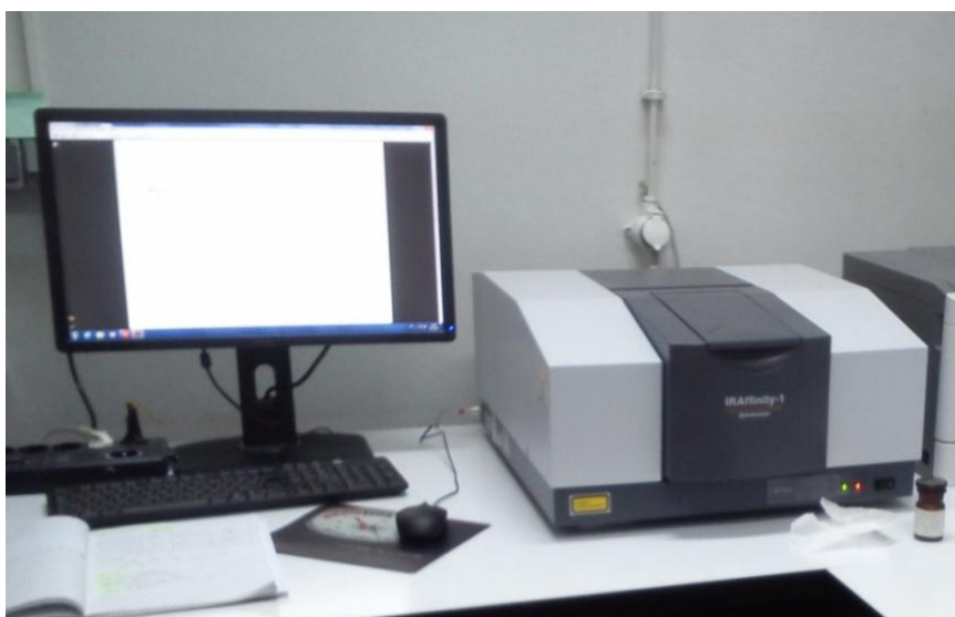
Slika 2.6 IRAffinity-1 FTIR spektrometar
