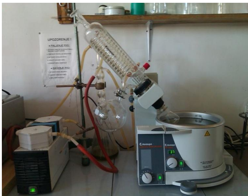
Slika 2.3 Rotacijski vakuum uparivač
