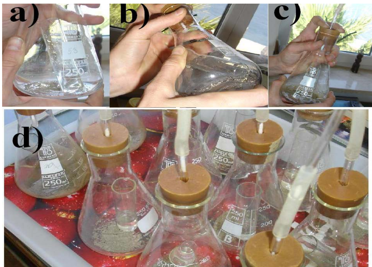
Slika 7. Određivanje karbonata u sedimentu gravimetrijskom metodom 144
