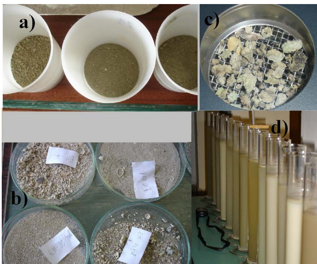
Slika 8. Granulometrijska analiza sedimenta: a) odvagani uzorci suhog sedimenta; b) čestice veće od 63\mu\text{m} koje su zaostale nakon mokrog prosijavanja; c) sito sa zaostalim česticama nakon suhog prosijavanja; d) suspenzija sa česticama manjim od 63\mu\text{m} koje se areometriraju
