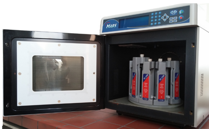
Slika 3.2. Mikrovalna peć za digestiju uzoraka CEM Mars 5, sa setom teflonskih posuda za razaranje uzoraka.
