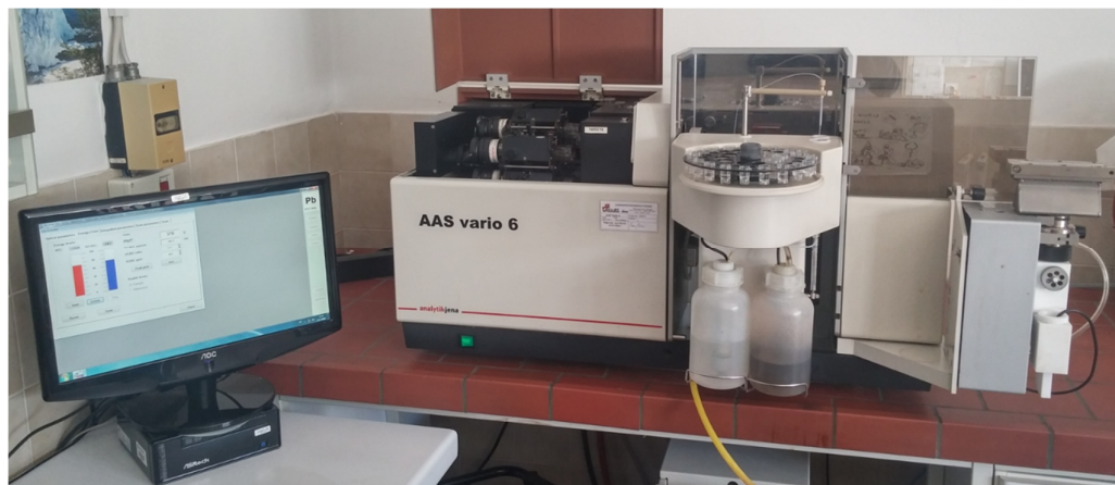
Slika 3.5. Atomski apsorpcijski spektrometar AnalytikJena AG, model AAS Vario 6.
