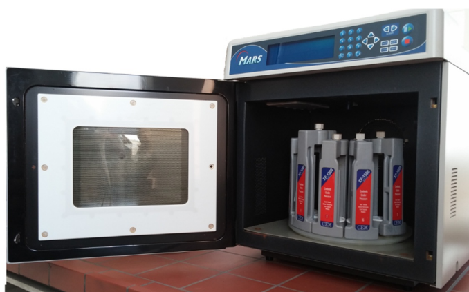
Slika 3.2. Mikrovalna peć za digestiju uzoraka CEM Mars 5, sa setom teflonskih posuda za razaranje uzoraka.
