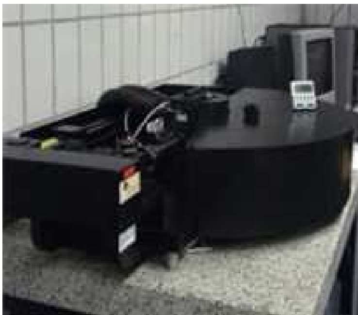
Slika 12. CGC-3 goniometar (ALV, Langen, Njemačka) opremljen sa ALV-7004 / FAST Multiple Tau digitalnim korelatorom.
