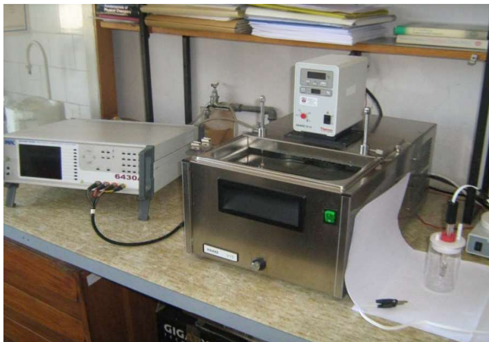
Slika 11. Aparatura i ćelija za mjerenje vodljivosti.
