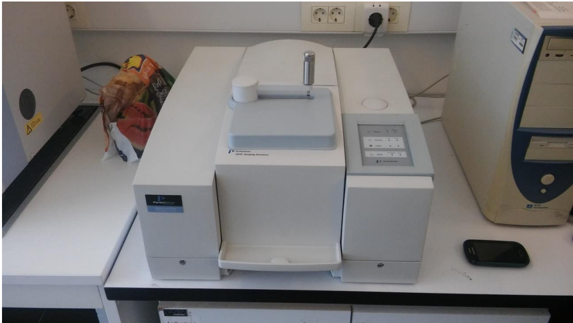
Slika 2.4. FTIR spektrometar Perkin-Elmer Spectrum One
