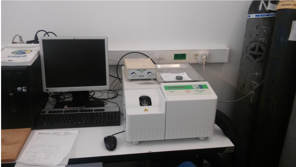
Slika 2.2. DSC uređaj DSC 823 e (Mettler Toledo)
