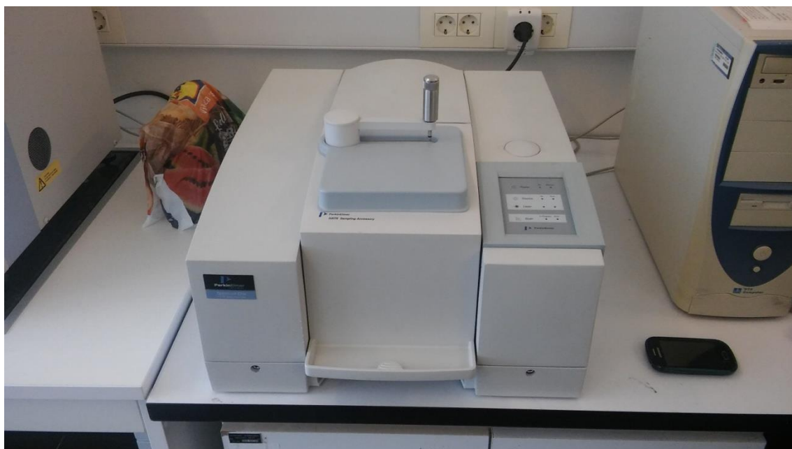
Slika 2.4. FTIR spektrometar Perkin-Elmer Spectrum One
