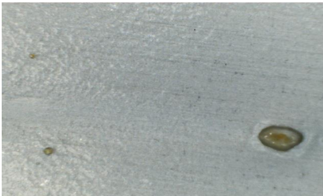
Slika 1.2. Primjer nastalog gela na površini materijala
