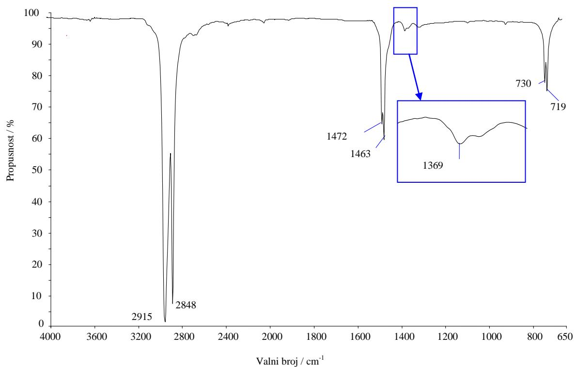
Slika 12. FT-IR spektar polietilena visoke gustoće (PE-HD)
