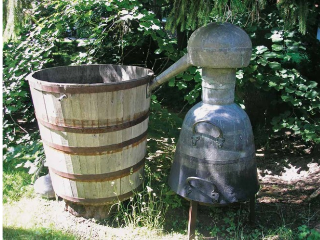
Slika 3. Alambik-klasični uređaj za dobivanje eteričnog ulja ruže hidrodestilacijom 1
