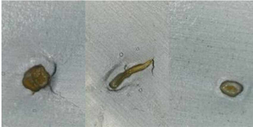
Slika 12. Prikaz nakupine gela na polipropilenskom filmu
