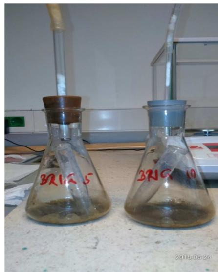
**Slika 10.** Određivanje karbonata u sedimentu gravimetrijskom metodom
