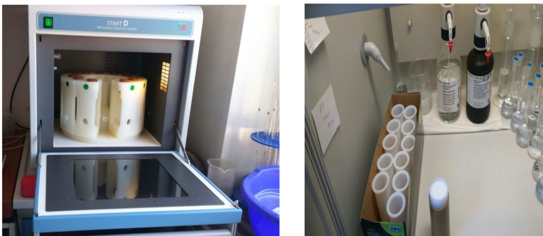
Slika 13. Razaranje uzoraka tla u mikrovalnoj peći
