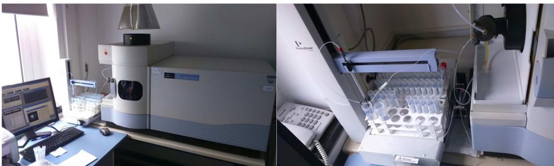
**Slika 14.** Određivanje sadržaja metala ICP-OES metodom
