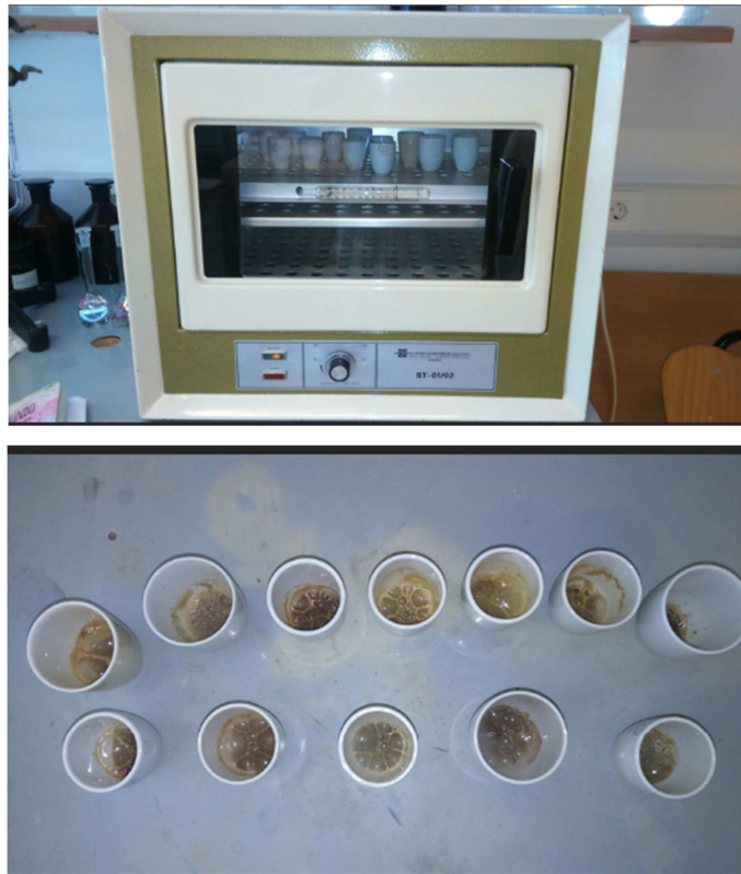
Slika 12. Određivanje organske tvari u sedimentu gravimetrijskom metodom
