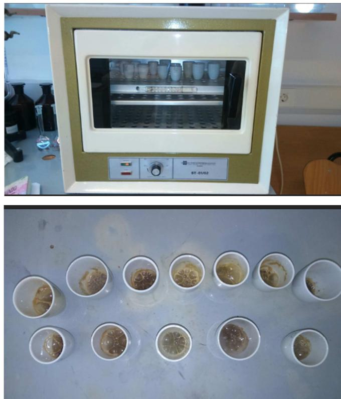
Slika 12. Određivanje organske tvari u sedimentu gravimetrijskom metodom
