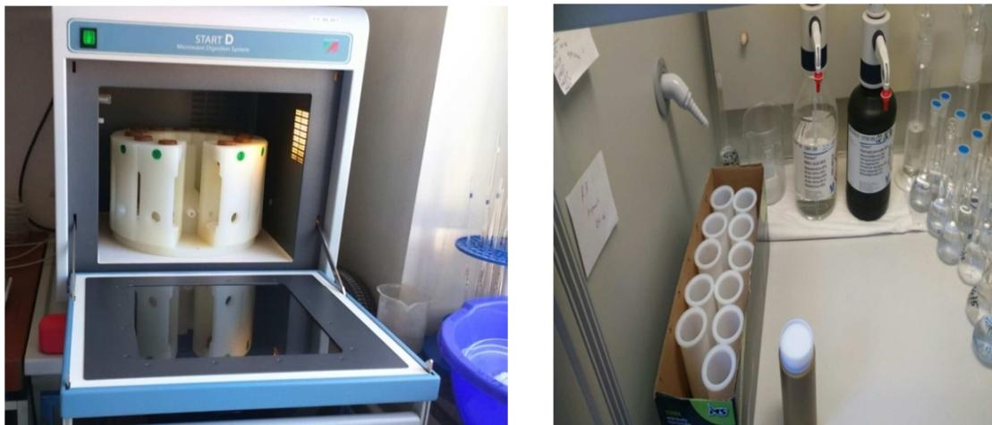
**Slika 13.** Razaranje uzorka tla u mikrovalnoj peći
