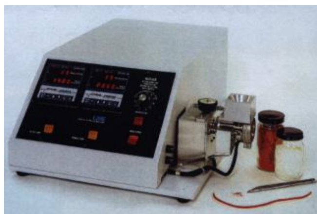
Slika 8. Jednopužni laboratorijski ekstruder DYNISCO LME 230
