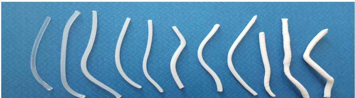
Slika 10. Ekstrudirani uzorci kompozita PLA/ Mg(OH)_2
