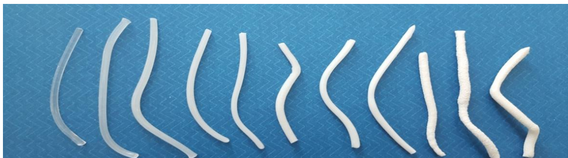
Slika 10. Ekstrudirani uzorci kompozita PLA/ Mg(OH)_2
