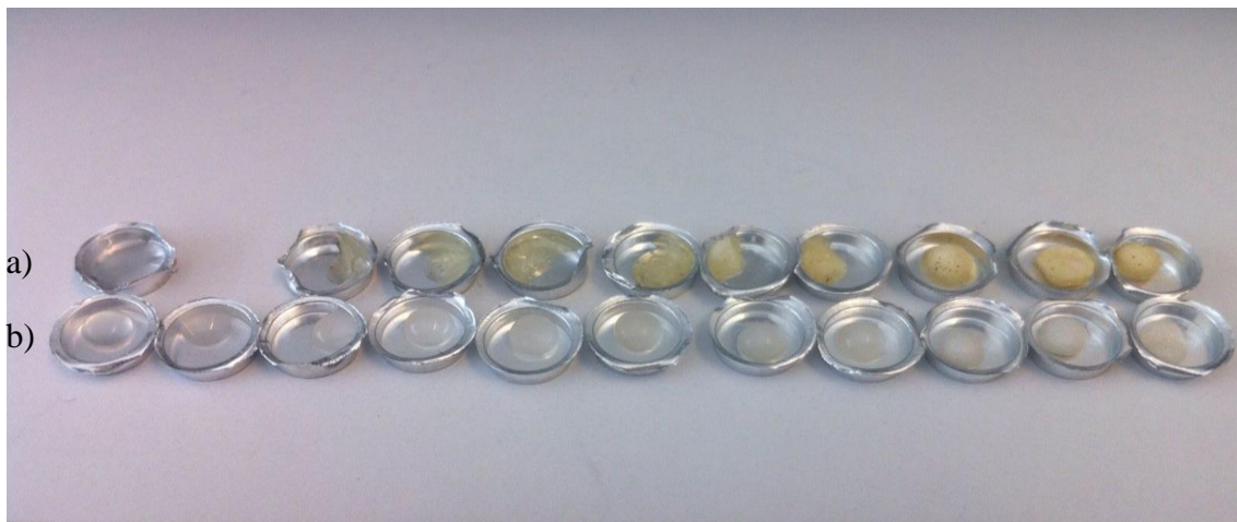
Slika 21. Ispitci u aluminijskim posudicama nakon DSC analize: a) metoda 1, b) metoda 2
