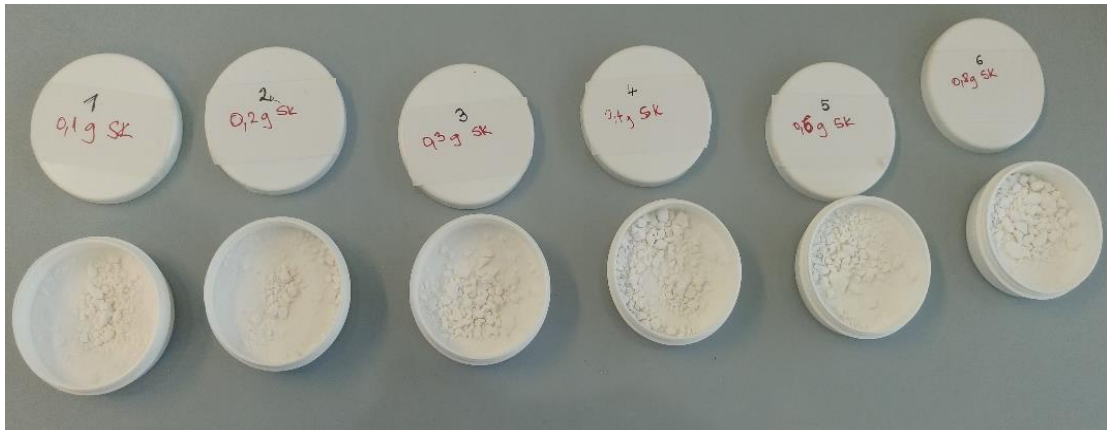
Slika 8. Prikaz uzoraka magnezijeva hidroksida nakon modifikacije sa otopinom stearinske kiseline u acetonu
