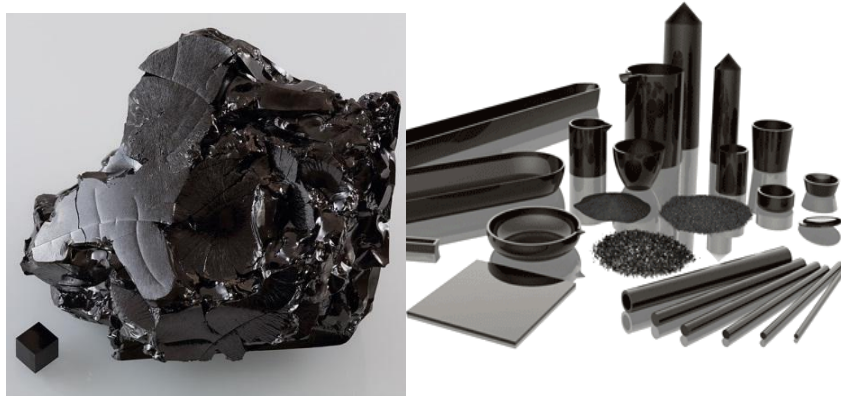
Slika 6. Struktura i materijali dobiveni iz staklastog ugljika. 18
