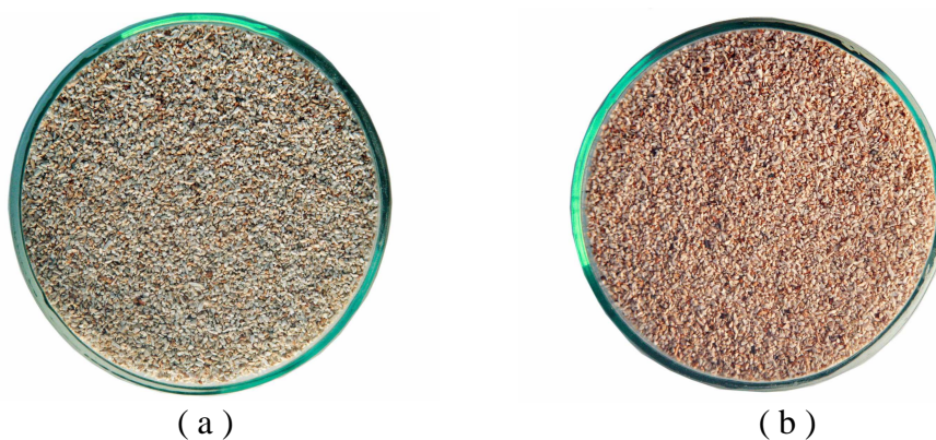
Slika 2.1. Usporedba prirodnog (a) i Fe(III)-modificiranog zeolita (b).
