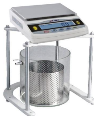
Slika 12b. Novija izvedba hidrostatske vage
