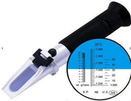
Slika 10. Prijenosni optički refraktometar s prikazom skale
