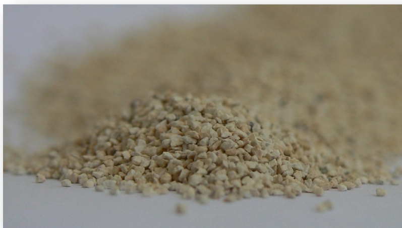
Slika 2.1. Uzorak zeolita klinoptilolita veličine čestica 0,6 - 0,8 mm.*
