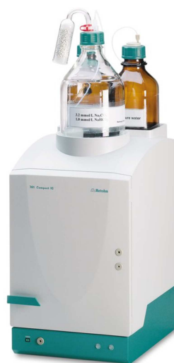
Slika 2.3. Ionski kromatograf "Metrohm 761 Compact IC".
