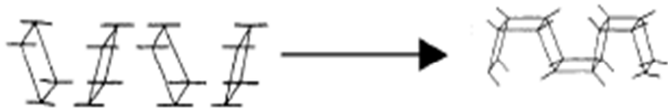
Slika 5. Mehanizam nastajanja zeolita prema Barreru
