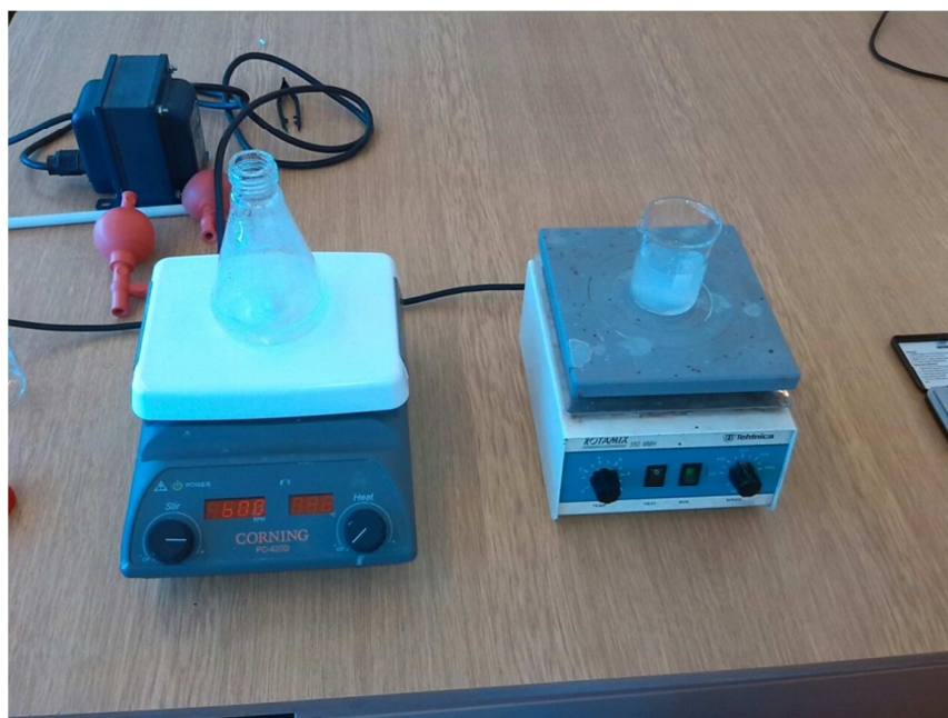
Slika 11. Otapanje natrijevog silikata i natrijevog aluminata u ultračistoj vodi
