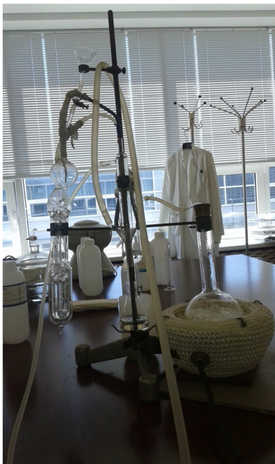
Slika 15. Aparatura za mikrodestilaciju po Kjeldahlu
