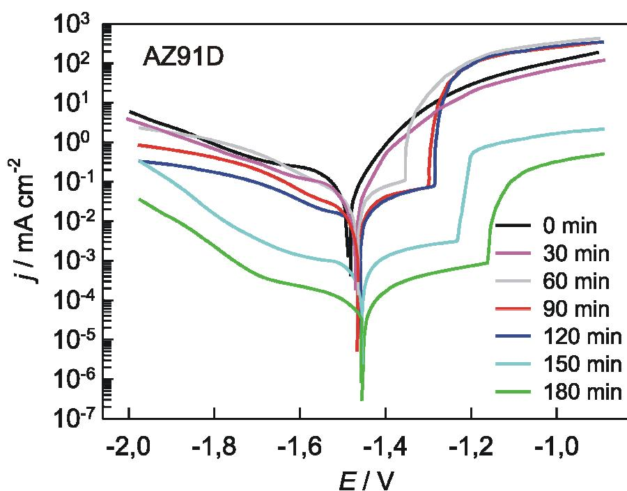
**Slika 4.30.** Tafelov prikaz polarizacijskih krivulja nemodificirane (0 min) i hidroksiapatitom modificirane AZ91D legure snimljenih u Hanksovoj otopini. Vrijeme elektrodepozicije prikazano na slici. Brzina promjene potencijala,  $v = 10 \text{ mV s}^{-1}$ .
