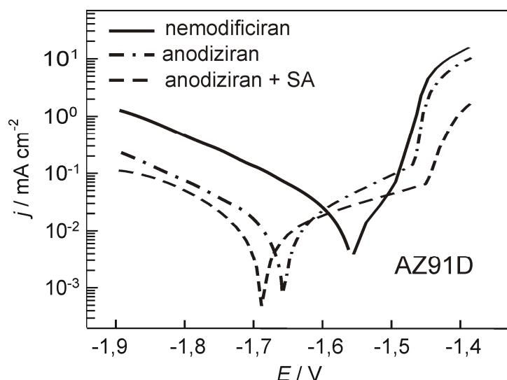
**Slika 5.4.** Tafelov prikaz polarizacijskih krivulja snimljenih u Hanksovoj otopini na nemodificiranoj, anodiziranoj i anodiziranoj i SAMom SA modificiranoj AZ91D leguri. Brzina promjene potencijala,  $v = 10 \text{ mV s}^{-1}$ .
