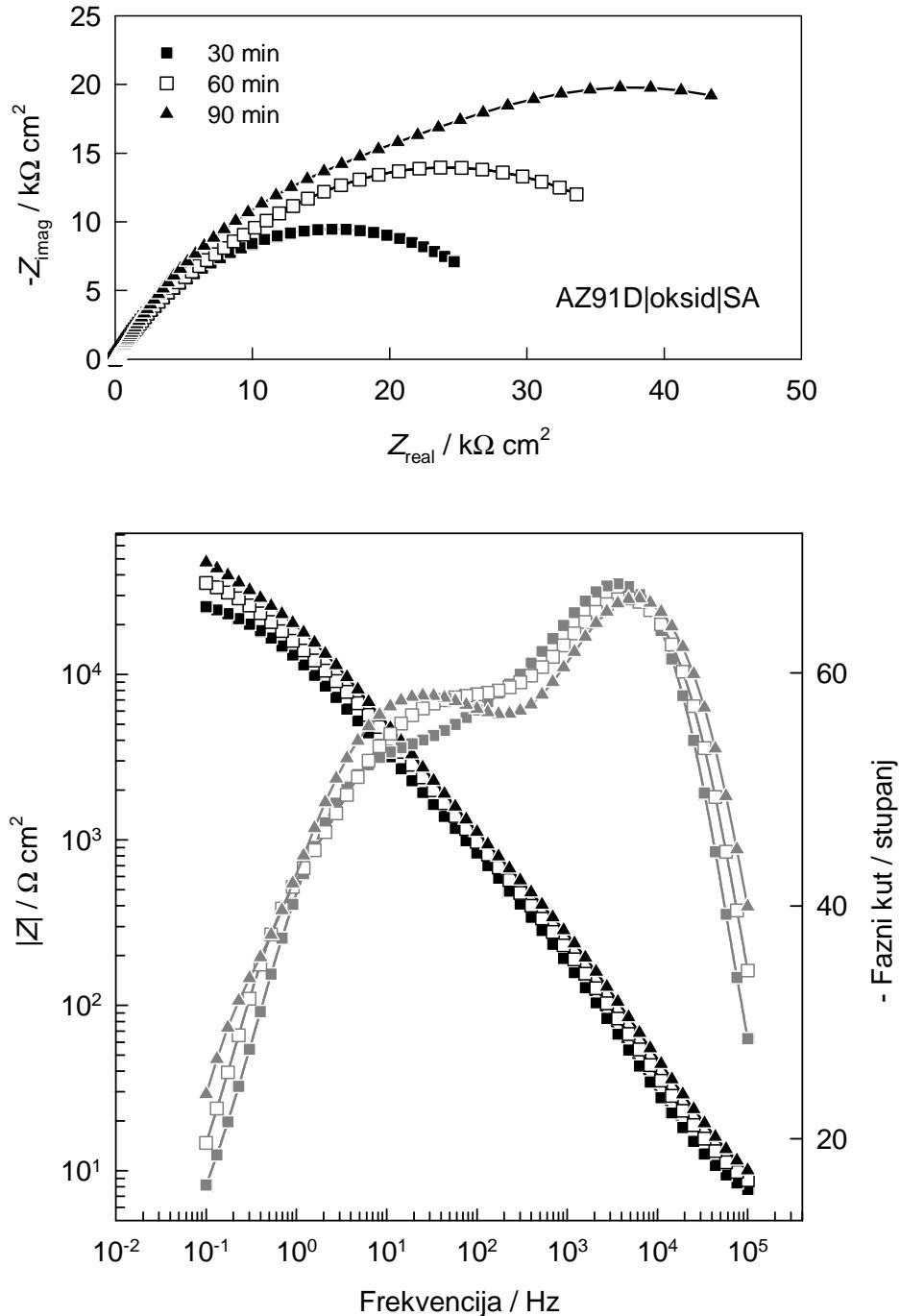
**Slika 4.11.** Nyquistov i Bodeov prikaz impedancijskih spektara anodizirane i SAMom SA modificirane AZ91D legure snimljenih u Hanksovoj otopini na potencijalu otvorenog strujnog kruga tijekom njenog boravka u elektrolitu. Vrijeme samoorganiziranja karboksilatnih filmova iznosio je 1 sat.
