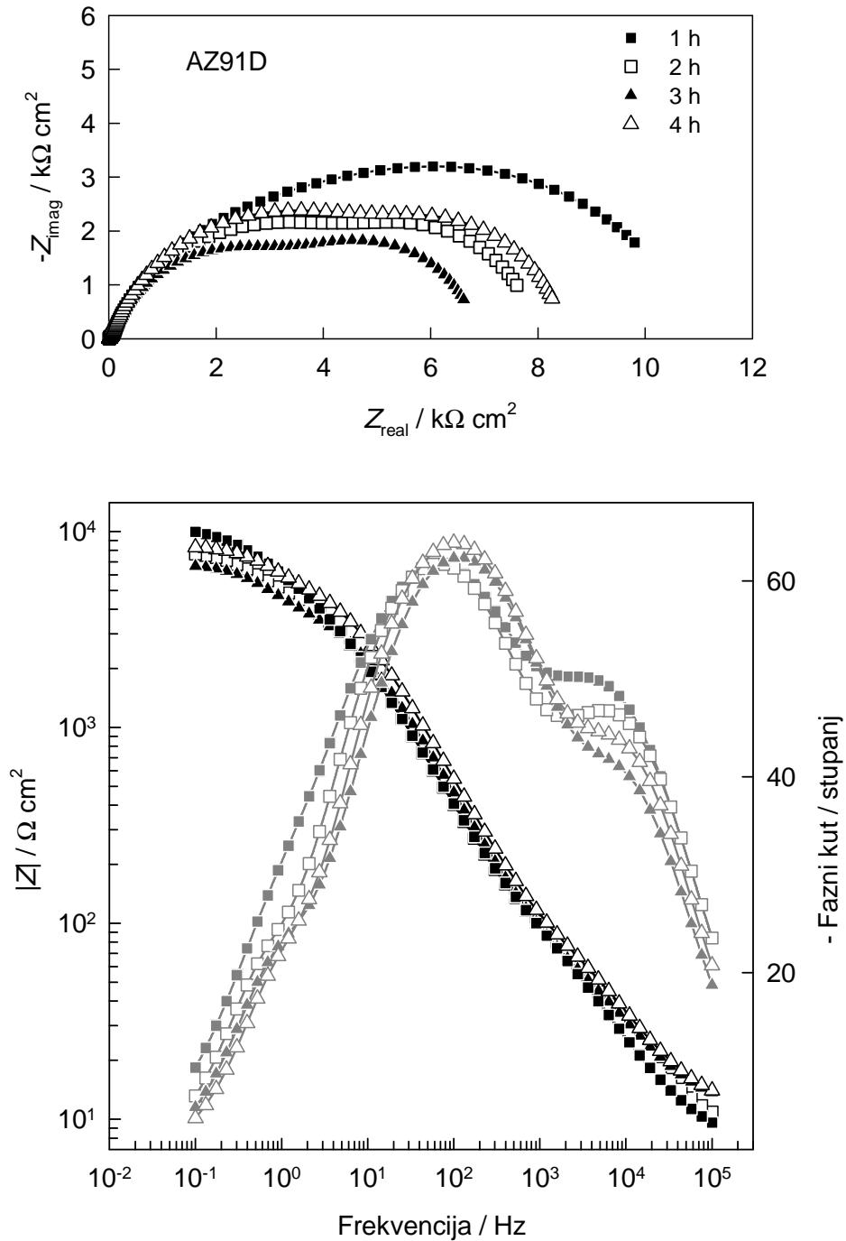
**Slika 4.18.** Nyquistov i Bodeov prikaz impedancijskih spektara SAMom DDPA modificirane AZ91D legure snimljenih u Hanksovoj otopini na potencijalu otvorenog strujnog kruga. Vrijeme samoorganiziranja naznačeno na slici.
