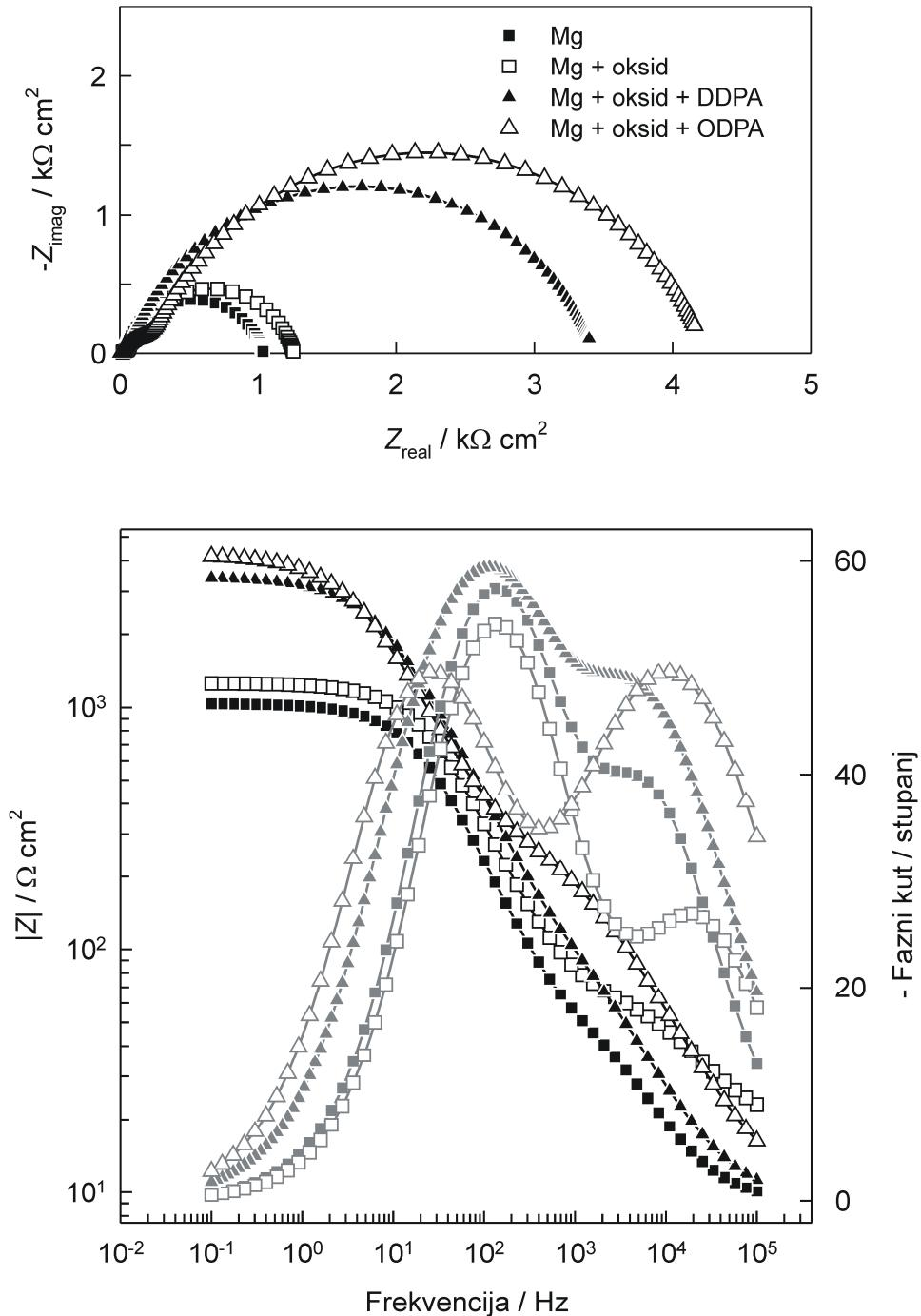
**Slika 4.20.** Nyquistov i Bodeov prikaz impedancijskih spektara nemodificiranog, anodiziranog i anodiziranog i SAMom fosfonske kiseline modificiranog magnezija snimljenih u Hanksovou otopini na potencijalu otvorenog strujnog kruga.
