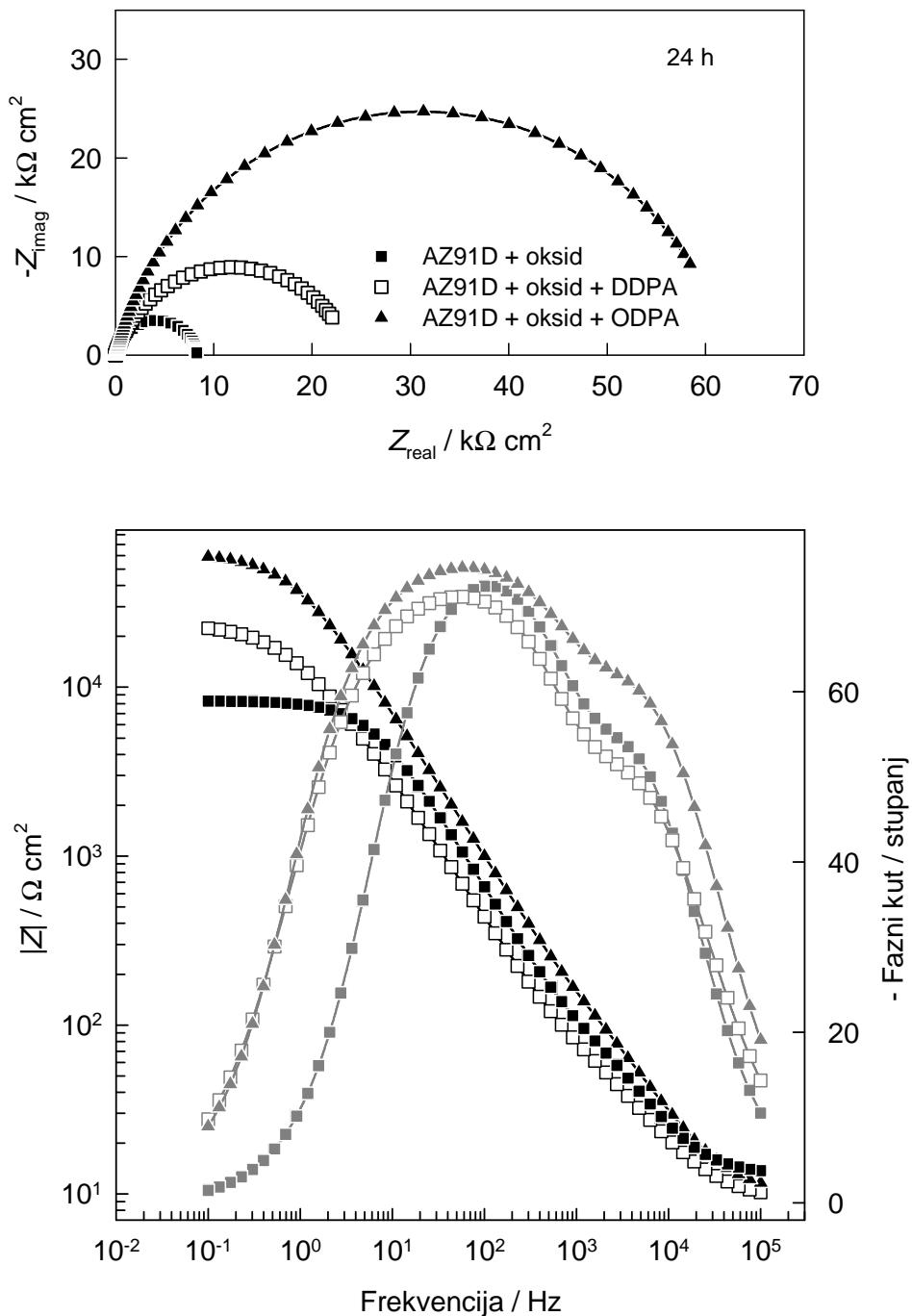
**Slika 4.25.** Nyquistov i Bodeov prikaz impedancijskih spektara AZ91D legure modificirane fosfonatnim SAMom zagrijavanim 24 sata na 120 °C snimljeni u Hanksovoj otopini na potencijalu otvorenog strujnog kruga. Za usporedbu su prikazani uzorci AZ91D legure zagrijavani 24 sata.
