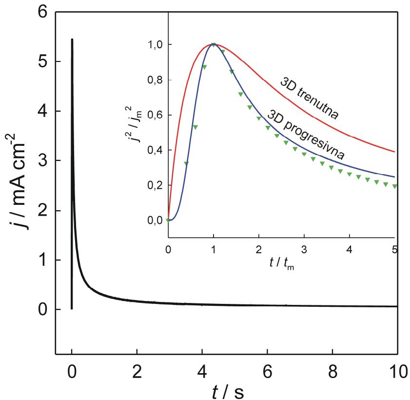
**Slika 5.1.** Struja – vrijeme tranzijent magnezija u boratnom elektrolitu, pH 12 pri 1,0 V vs. Ag/AgCl. Detalj: Normalizirani eksperimentalni tranzijent ( $\blacktriangledown$ ) uspoređen s teorijskom krivuljom 3D trenutne (crvena krivulja) i 3D progresivne nukleacije oksidnog filma.
