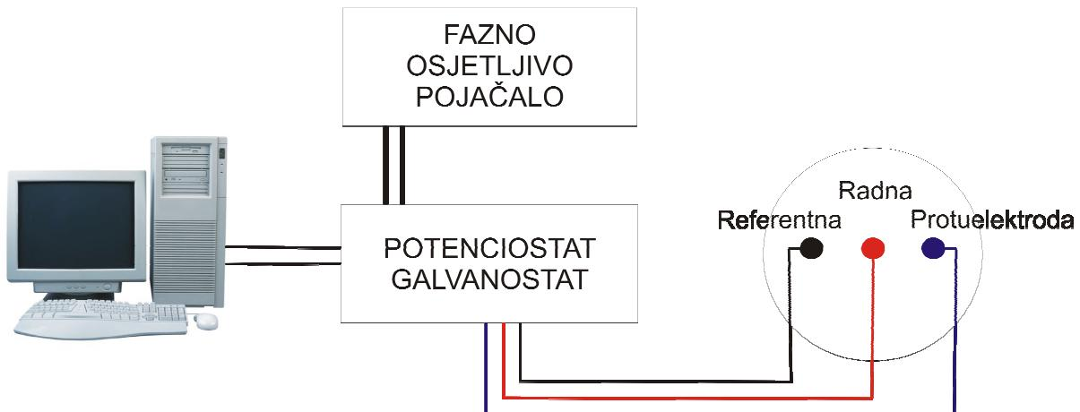
**Slika 3.3.** Shematski prikaz aparature za elektrokemijska mjerena.
