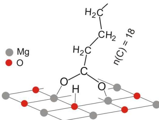
Slika 5.7. Shematski prikaz vezanja karboksilne kiseline na površinu AZ91D legure.
