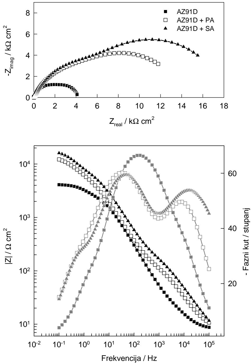
**Slika 4.7.** Nyquistov i Bodeov prikaz impedancijskih spektara nemodificirane i SAMom karboksilne kiseline modificirane AZ91D legure snimljenih u Hanksovoj otopini na potencijalu otvorenog strujnog kruga.
