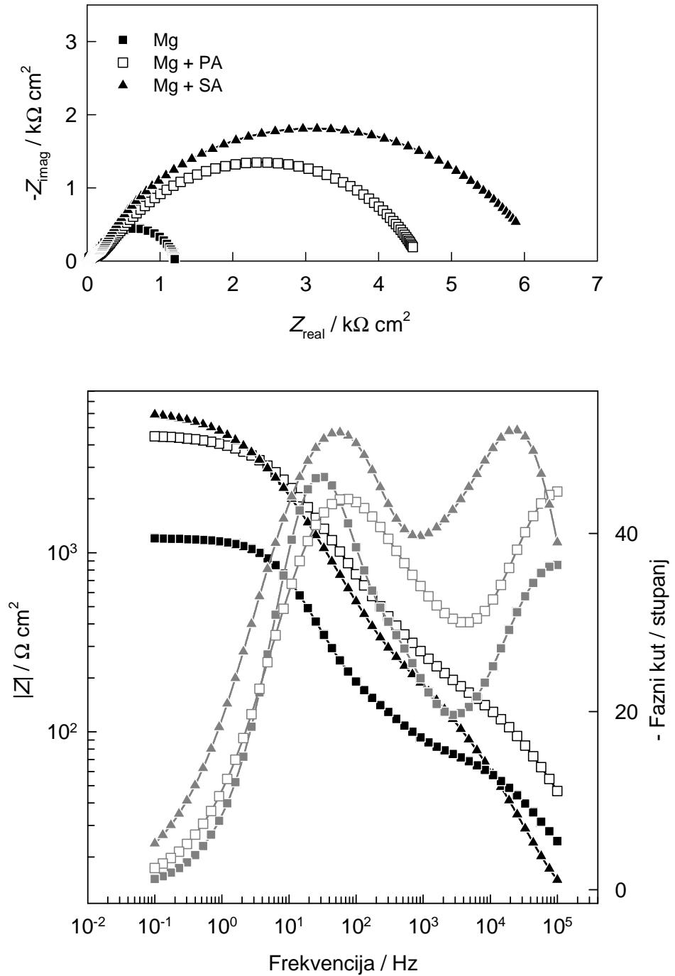
**Slika 4.12.** Nyquistov i Bodeov prikaz impedancijskih spektara nemodificiranog i SAMom karboksilne kiseline modificiranog magnezija snimljenih u Hanksovoj otopini na potencijalu otvorenog strujnog kruga.
