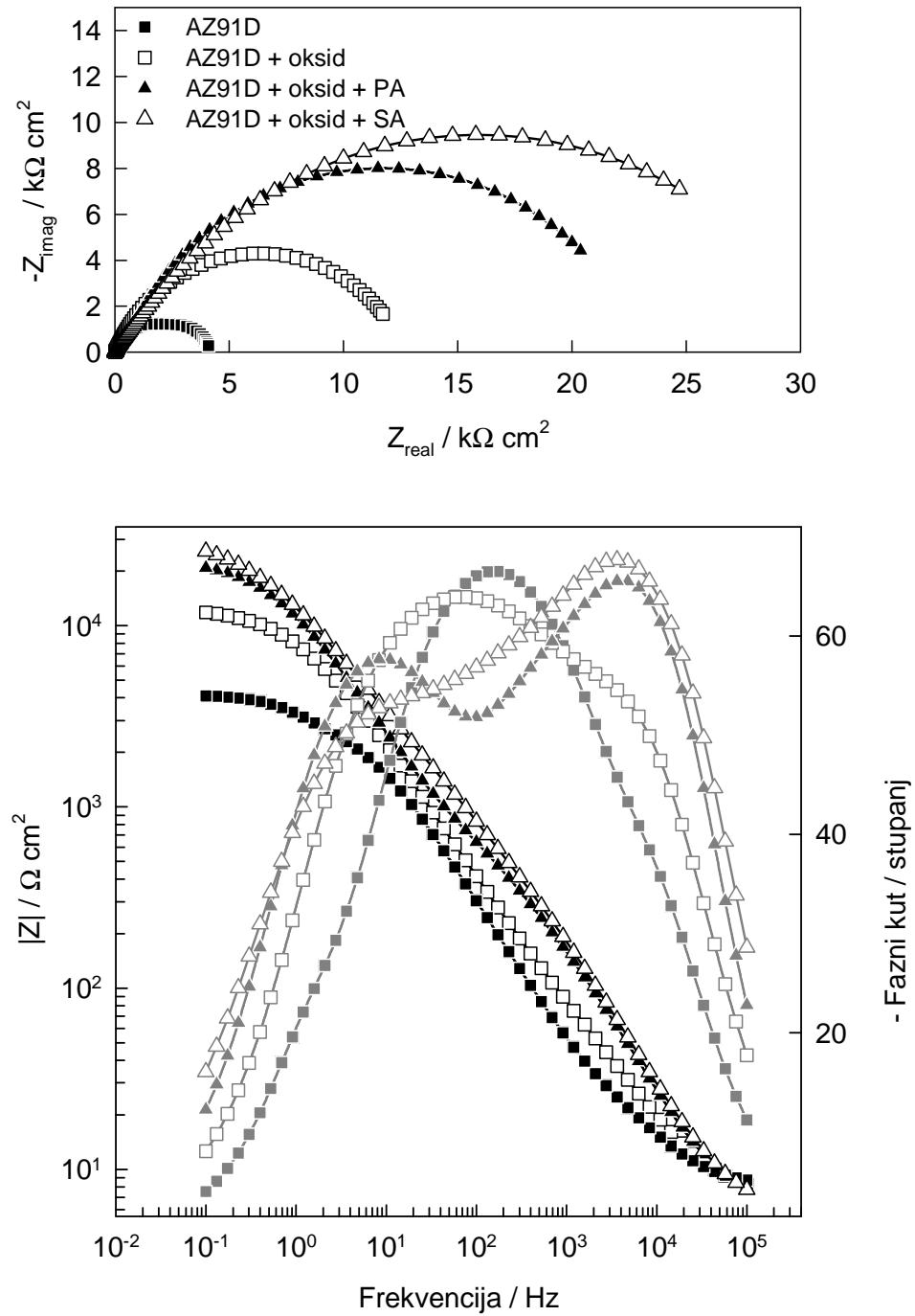
**Slika 4.9.** Nyquistov i Bodeov prikaz impedancijskih spektara nemodificirane, anodizirane i anodizirane i SAMom karboksilne kiseline modificirane AZ91D legure snimljenih u Hanksovoj otopini na potencijalu otvorenog strujnog kruga. Vrijeme samoorganiziranja karboksilatnih filmova iznosio je 1 sat.
