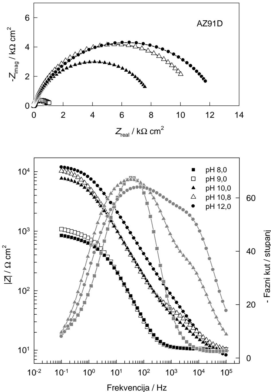
**Slika 4.6.** Nyquistov prikaz impedancijskih spektara AZ91D legure sa potencijostatski izgrađenim oksidnim filmom u boratnom elektrolitu određenog pH snimljenih u Hanksovoj otopini na potencijalu otvorenog strujnog kruga.
