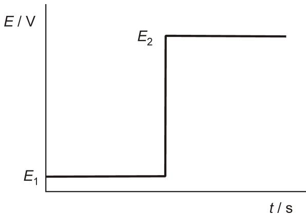
**Slika 2.4.** Ovisnost potencijala o vremenu u kronoamperometrijskom eksperimentu.
