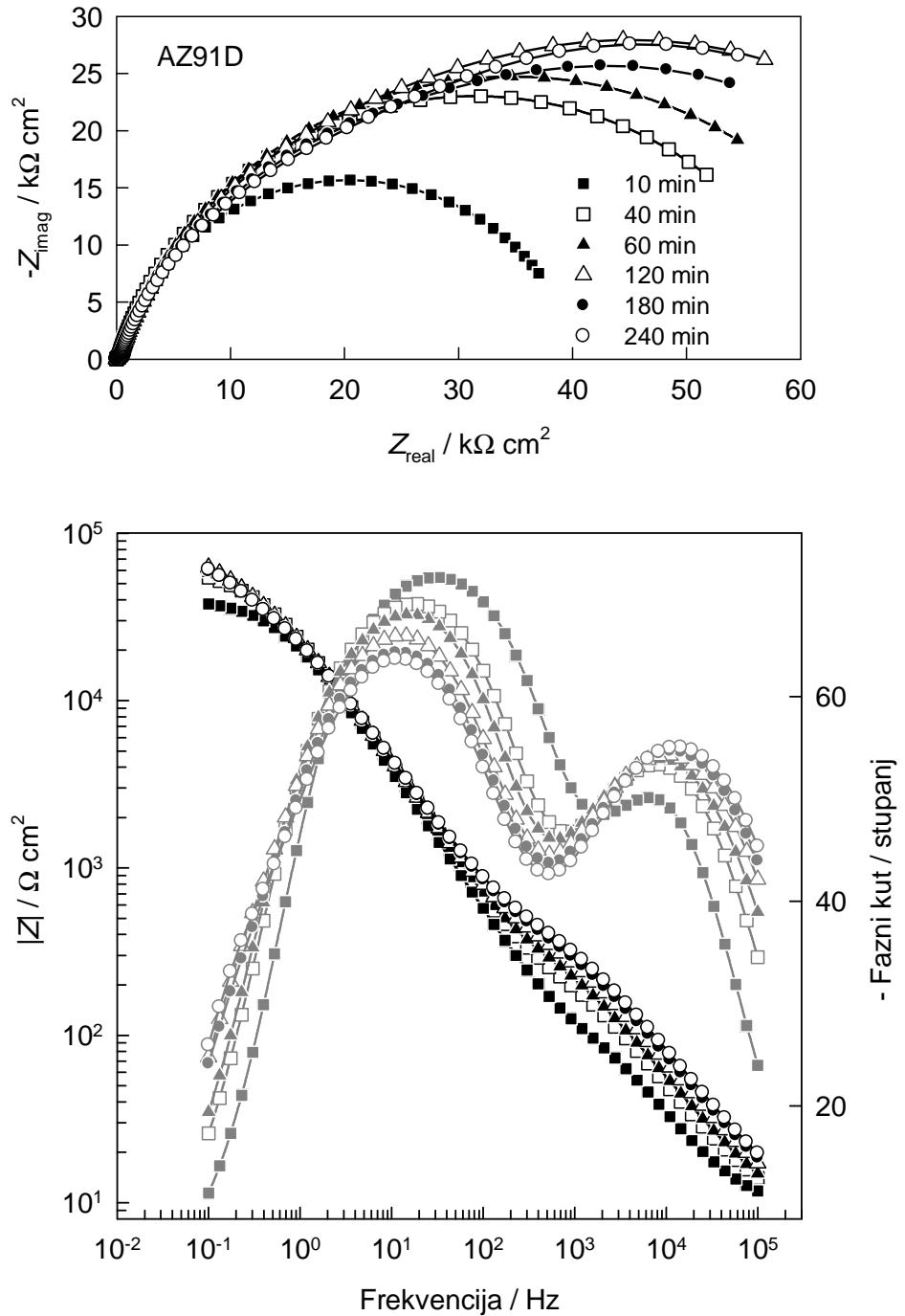
**Slika 4.23.** Nyquistov i Bodeov prikaz impedancijskih spektara SAMom ODPA modificirane AZ91D legure snimljenih u Hanksовоj otopini na potencijalu otvorenog strujnog kruga tijekom njenog boravka u elektrolitu.
