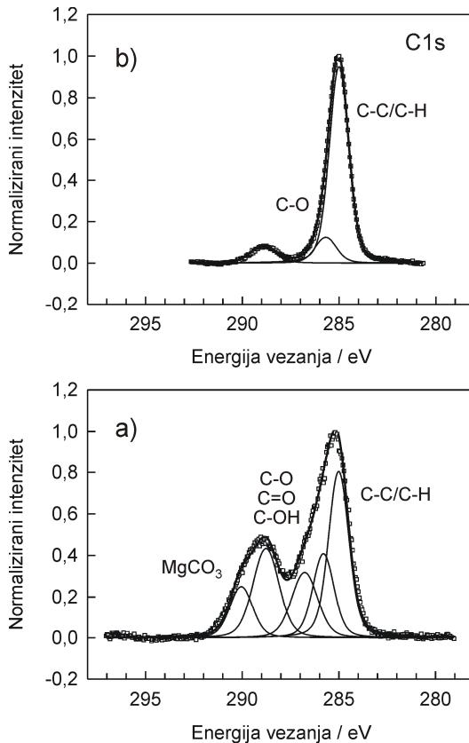
**Slika 5.6.** Dekonvolucijski XPS spektri C 1s elektrona uзорака AZ91D legure: (a) anodizirana i (b) anodizirana i modificirana SAMom SA.
