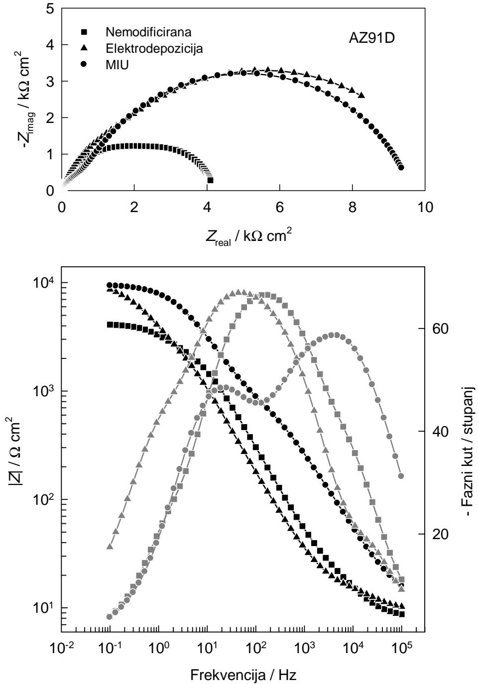
**Slika 4.31.** Nyquistov i Bodeov prikaz impedancijskih spektara nemodificirane i hidroksiapatitom modificirane AZ91D legure snimljenih u Hanksovoj otopini na potencijalu otvorenog strujnog kruga. (Naznačene su dvije različite metode modificiranja površine.)
