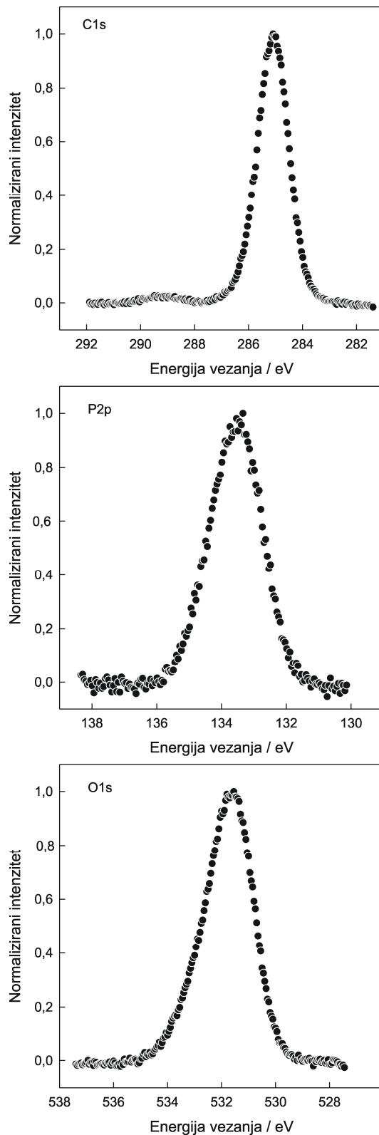
**Slika 4.26.** XPS spektri C 1s, P 2p i O 1s elektrona uzorka AZ91D legure sa termički (24 sata na  $120^{\circ}\text{C}$ ) tretiranim prirodnim oksidnim filmom modificiranim SAMom dodecilfosfonske kiseline.
