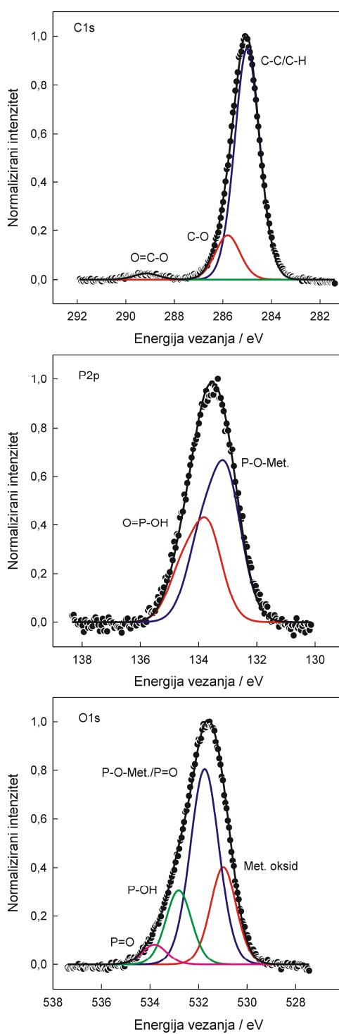
**Slika 5.9.** Dekonvolucijski XPS spektri C 1s, P 2p i O 1s elektrona uzorka AZ91D legure sa termički (24 h na 120°C) tretiranim oksidnim filmom modificiranim SAMom dodecilfosfonske kiseline.
