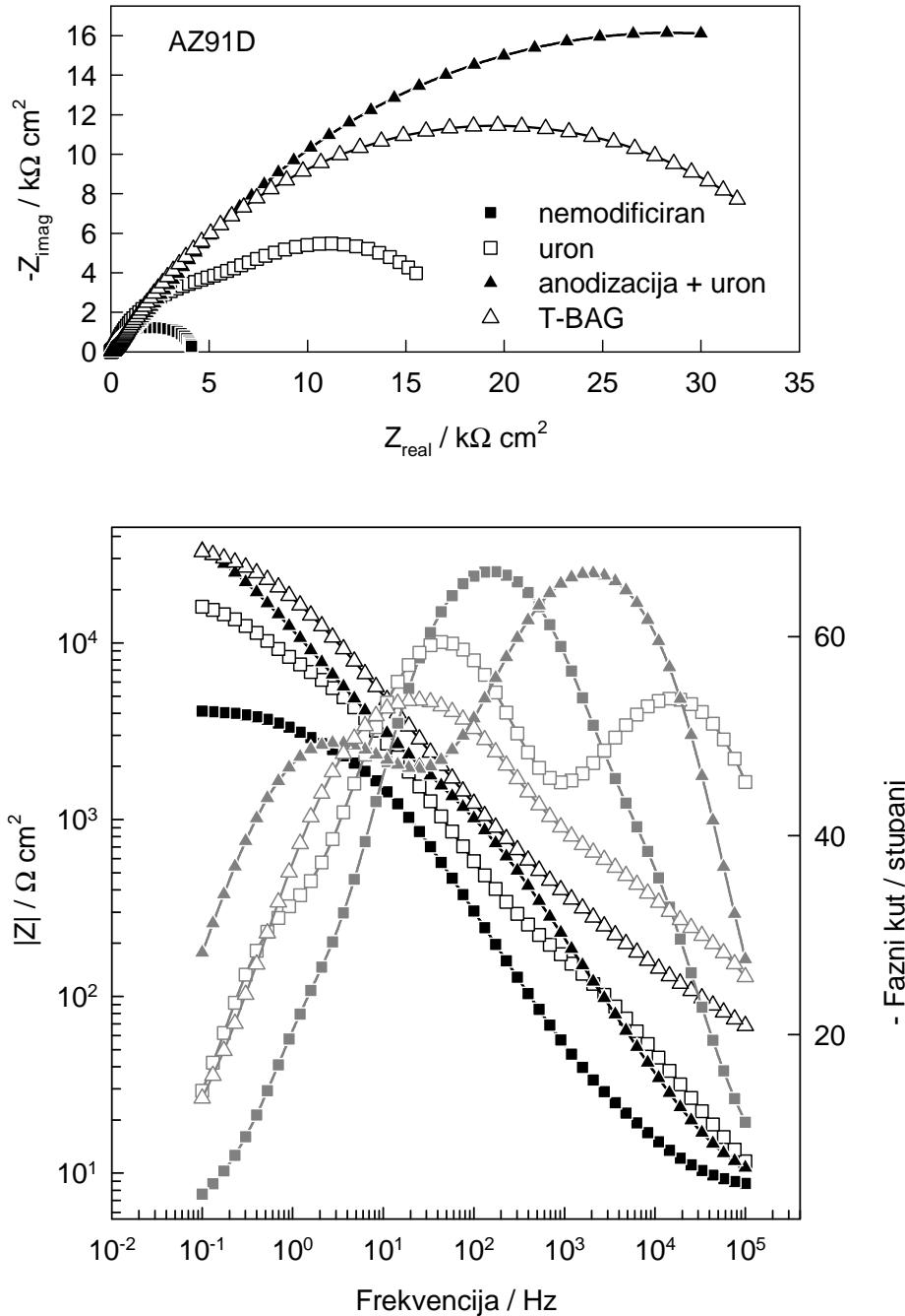
**Slika 5.3.** Nyquistov i Bodeov prikaz impedancijskih spektara nemodificirane i SAMom SA modificirane AZ91D legure snimljenih u Hanksovoj otopini na potencijalu otvorenog strujnog kruga. (Naznačene su tri različite metode modificiranja površine.)
