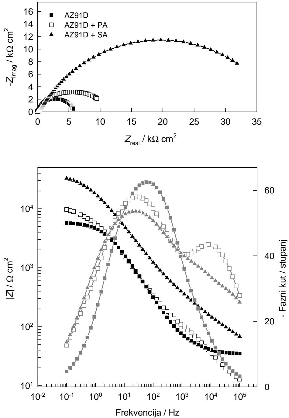
**Slika 4.13.** Nyquistov i Bodeov prikaz impedancijskih spektara nemodificirane i SAMom karboksilne kiseline modificirane AZ91D legure snimljenih u Hanksovoj otopini na potencijalu otvorenog strujnog kruga.
