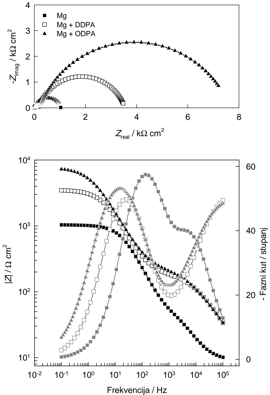
**Slika 4.21.** Nyquistov i Bodeov prikaz impedancijskih spektara nemodificiranog i SAMom fosfonske kiseline modificiranog magnezija snimljenih u Hanksovoj otopini na potencijalu otvorenog strujnog kruga.
