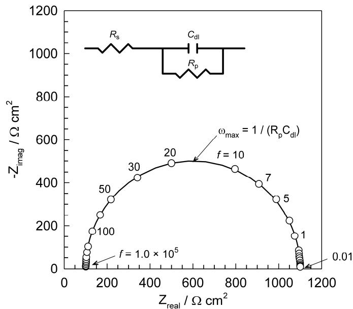
**Slika 2.6.** Nyquistov prikaz impedancijskog spektra ekvivalentnog strujnog kruga.
