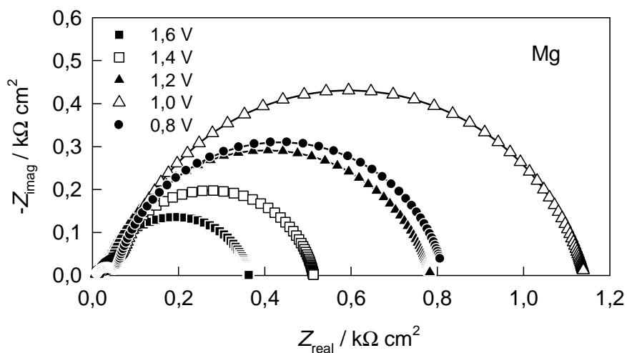
**Slika 4.5.** Nyquistov prikaz impedancijskih spektara magnezija sa potencijostatski izgrađenim oksidnim filmom na odabranom potencijalu snimljenih u Hanksovoj otopini na potencijalu otvorenog strujnog kruga.
