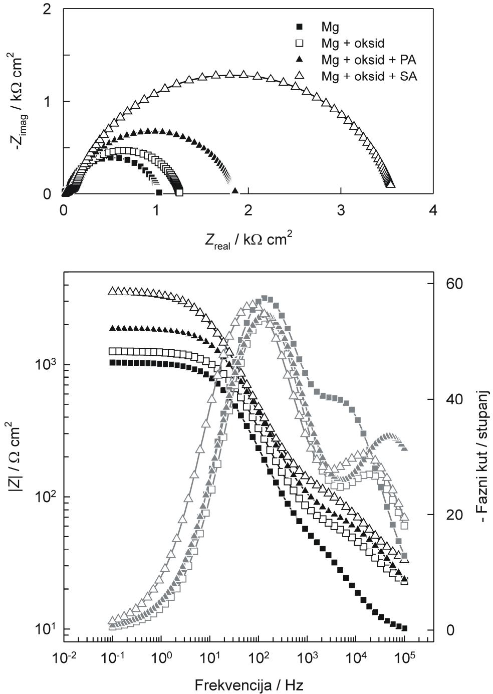
**Slika 4.8.** Nyquistov i Bodeov prikaz impedancijskih spektara nemodificiranog, anodiziranog i anodiziranog i SAMom karboksilne kiseline modificiranog magnezija snimljenih u Hanksovoj otopini na potencijalu otvorenog strujnog kruga.
