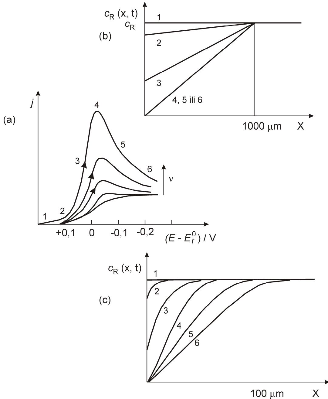
**Slika 2.2.** Utjecaj brzine promjene potencijala na  $j$ - $E$  odziv: (a)  $j$ - $E$  krivulje snimljene u stacionarnom stanju s rastućom brzinom promjene potencijala; (b) razvoj koncentracijskih profila za vrijeme stacionarnog stanja pri odvijanju eksperimenta, i (c) razvoj koncentracijskih profila za vrijeme polaznog dijela ciklusa cikličkog voltamograma.
