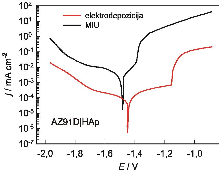
**Slika 4.32.** Tafelov prikaz polarizacijskih krivulja hidroksiapatitom modificirane AZ91D legure snimljenih u Hanksovoj otopini. Brzina promjene potencijala,  $v = 10 \text{ mV s}^{-1}$ . (Naznačene su dvije različite metode modificiranja površine.)
