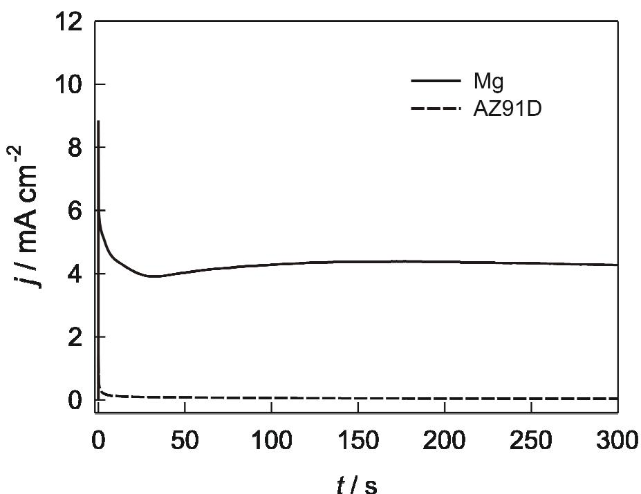
**Slika 4.3.** Potencijostatski tranzijenti snimljeni na elektrodama od magnezija i AZ91D legure u otopini boratnog elektrolita, pH 12. Potencijal tranzijenta  $E_t = 1,0 \text{ V}$ .
