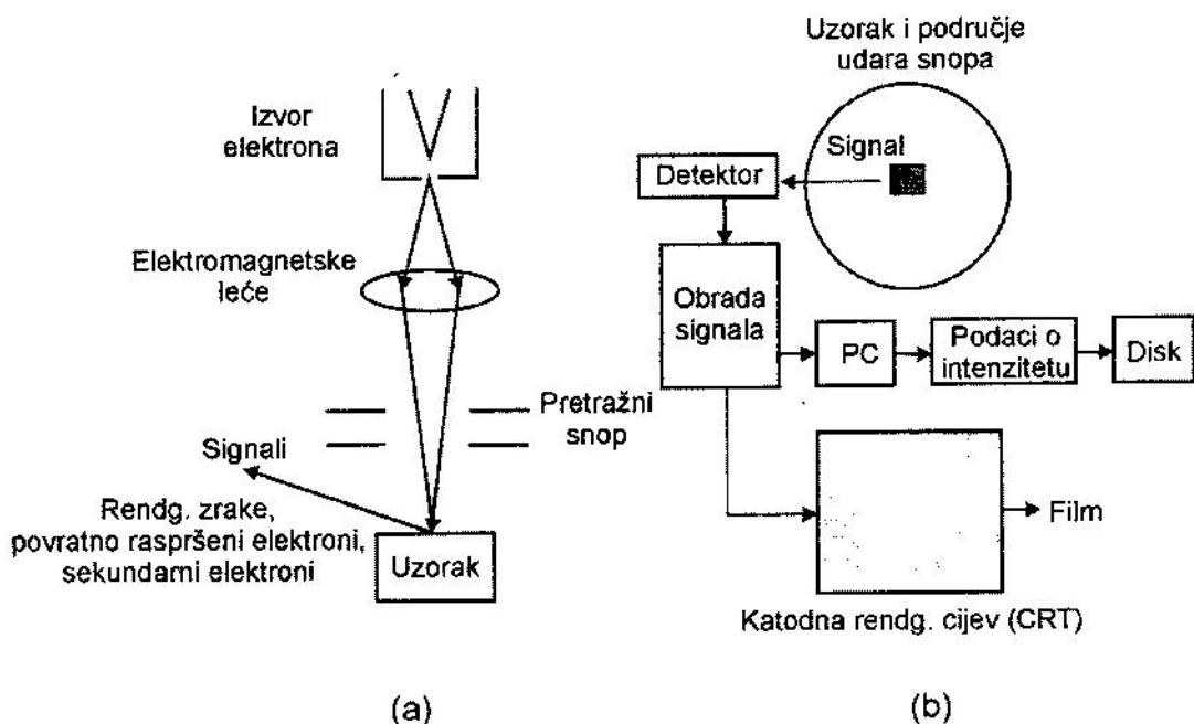
**Slika 2.13.** Shematski prikaz pretražnog elektronskog mikroskopa. Nastanak elektronskog snopa i fokusiranje u točku na površini uzorka (a). Pojačavanje detektiranih signala za različite analize (b).
