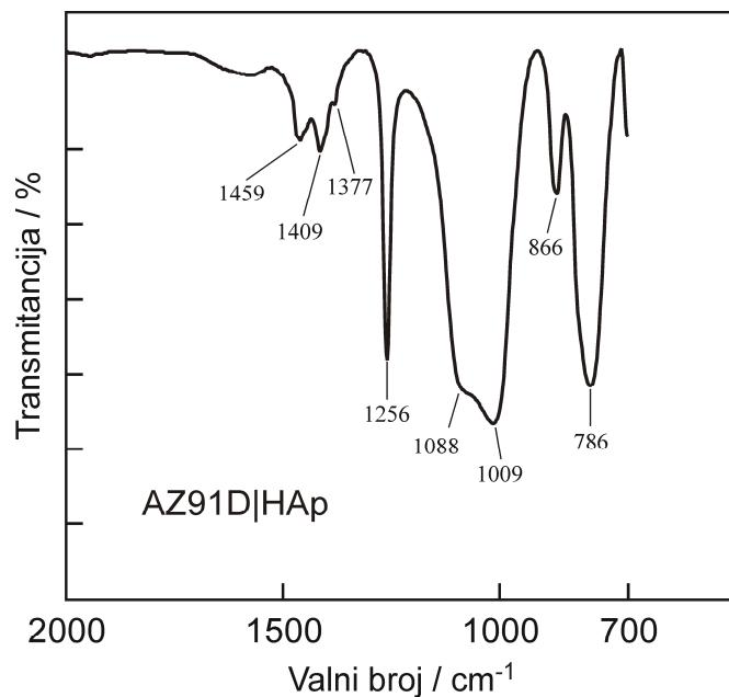
**Slika 4.33.** FTIR spektar AZ91D legure na koju je elektrodeponiran hidroksiapatit (HAp, Ca<sub>10</sub>(PO<sub>4</sub>)<sub>6</sub>(OH)<sub>2</sub>).
