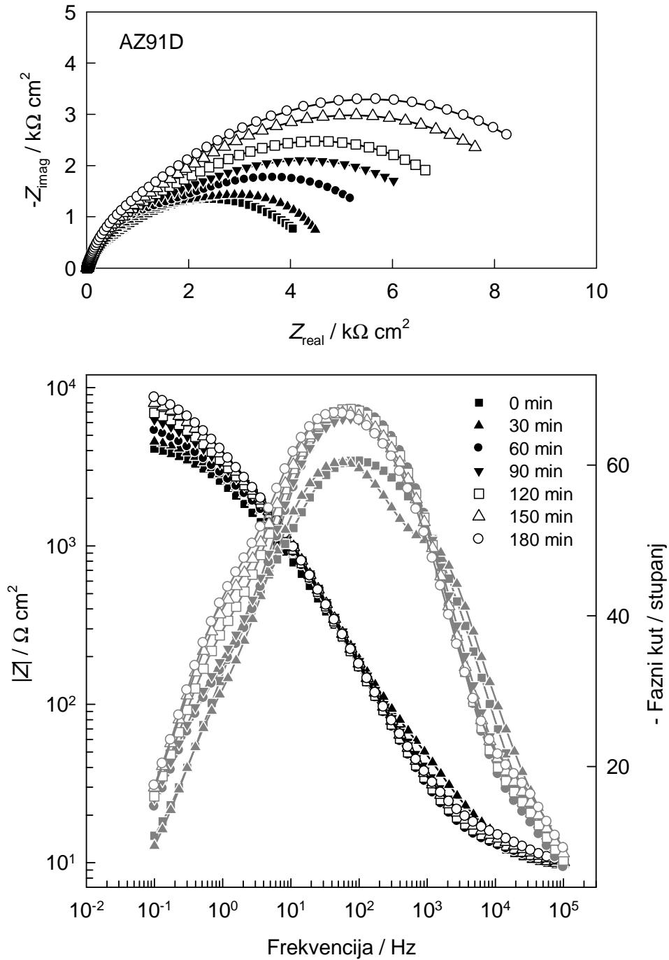
**Slika 4.29.** Nyquistov i Bodeov prikaz impedancijskih spektara nemodificirane i hidroksiapatitom modificirane AZ91D legure snimljenih u Hanksovoj otopini na potencijalu otvorenog strujnog kruga. Vrijeme elektrodepozicije prikazano na slici.
