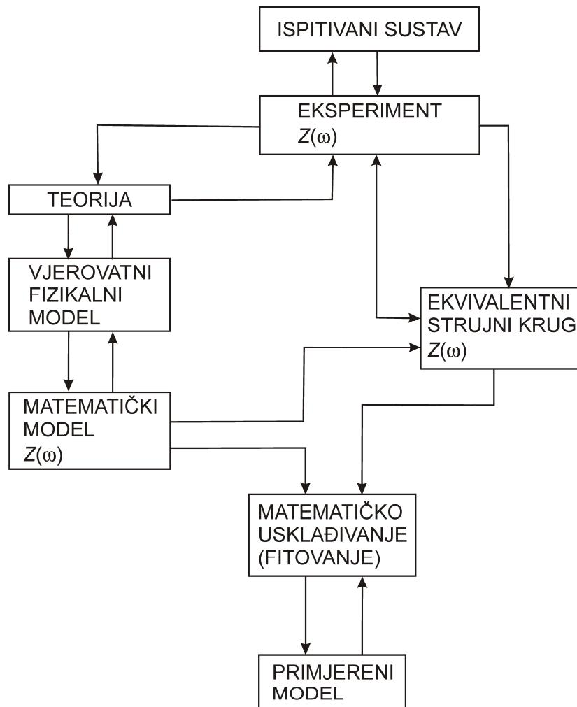
**Slika 2.8.** Dijagram toka analize eksperimentalno dobivenog impedancijskog spektra.
