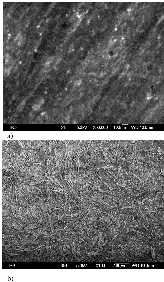
**Slika 4.34.** Snimak pretražnim elektronskim mikroskopom: a) nemodificirane površine AZ91D legure, b) površine AZ91D legure s elektrokemijski formiranim slojem hidroksiapatita.
