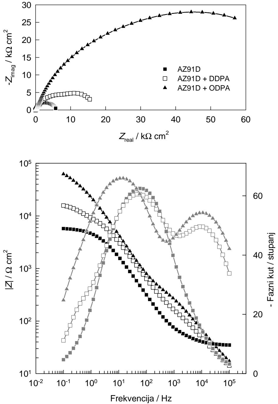
**Slika 4.22.** Nyquistov i Bodeov prikaz impedancijskih spektara nemodificirane i SAMOM fosfonske kiseline modificirane AZ91D legure snimljenih u Hanksовоj otopini na potencijalu otvorenog strujnog kruga.
