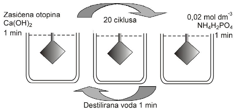
Slika 3.2. Metoda izmjeničnog uranjanja (MIU).
