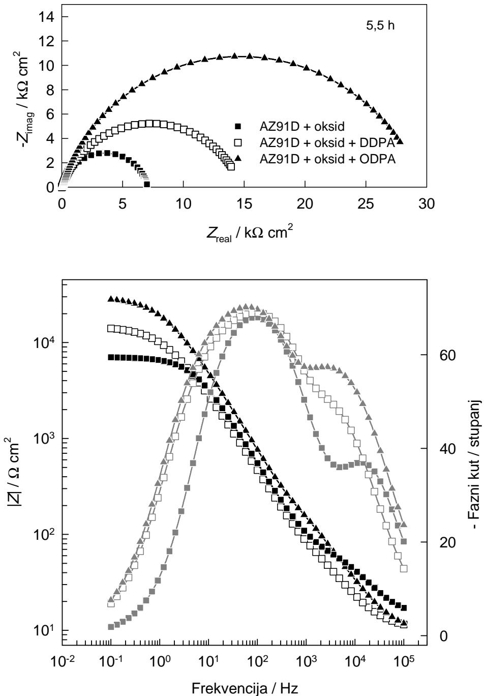
**Slika 4.24.** Nyquistov i Bodeov prikaz impedancijskih spektara AZ91D legure modificirane fosfonatnim SAMom zagrijavanim 5,5 sati na 120 °C snimljeni u Hanksovoj otopini na potencijalu otvorenog strujnog kruga. Za usporedbu su prikazani uzorci AZ91D legure zagrijavani 5,5 sati.
