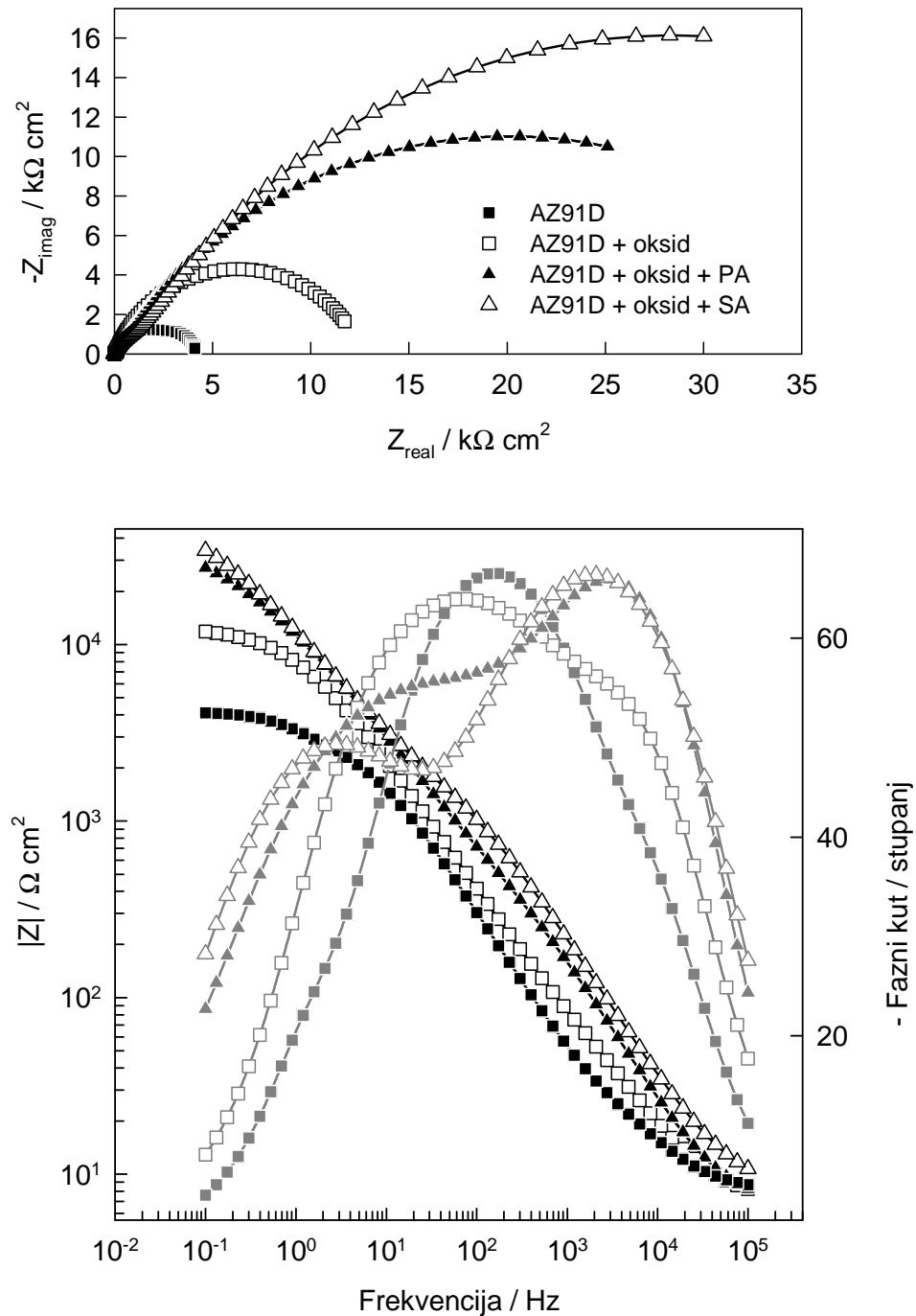
**Slika 4.10.** Nyquistov i Bodeov prikaz impedancijskih spektara nemodificirane, anodizirane i anodizirane i SAMom karboksilne kiseline modificirane AZ91D legure snimljenih u Hanksovoj otopini na potencijalu otvorenog strujnog kruga. Vrijeme samoorganiziranja karboksilatnih filmova iznosio je 24 sata.
