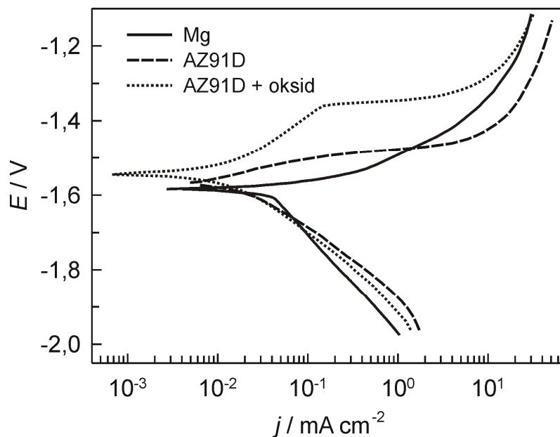
**Slika 5.2.** Tafelov prikaz polarizacijskih krivulja snimljenih u Hanksovoj otopini na nemodificiranom magneziju, nemodificiranoj AZ91D leguri i anodiziranoj AZ91D leguri. Brzina promjene potencijala,  $v = 10 \text{ mV s}^{-1}$ .
