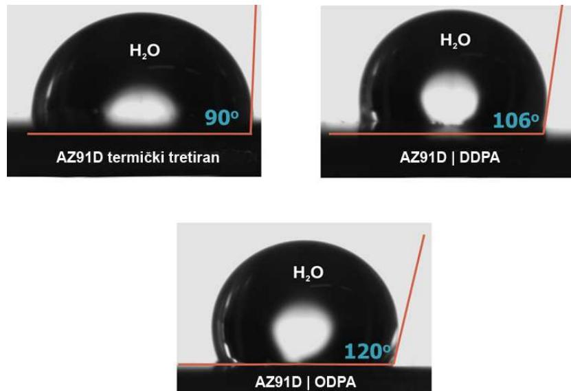
**Slika 4.28.** Kontaktni kut koji kapljica vode zatvara sa modificiranim površinom AZ91D legure [90].
