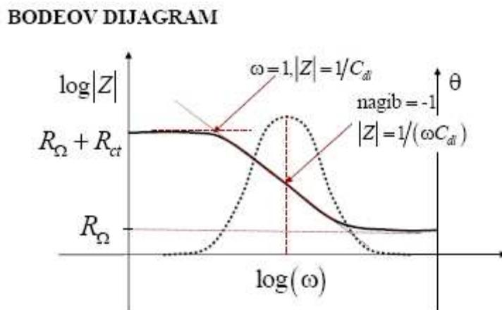
**Slika 2.7.** Bodeov prikaz impedancijskog spektra ekvivalentnog strujnog kruga.
