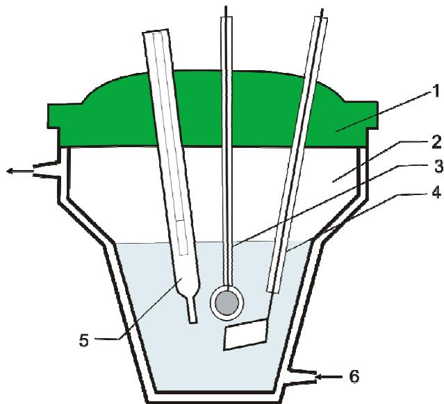
**Slika 3.1.** Shema elektrokemijskog reaktora korištenog u radu. 1. poklopac reaktora, 2. elektrokemijski reaktor, 3. radna elektroda, 4. protuelektroda, 5. referentna elektroda, 6. ulaz vode iz termostata.
