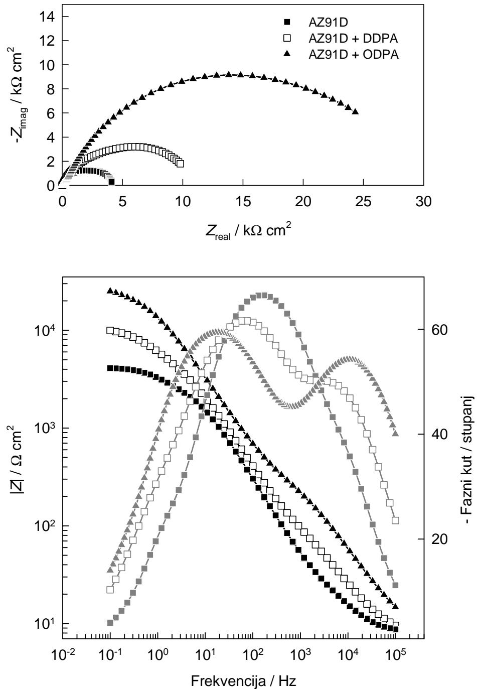
**Slika 4.19.** Nyquistov i Bodeov prikaz impedancijskih spektara nemodificirane i SAMOM fosfonske kiseline modificirane AZ91D legure snimljenih u Hanksovoj otopini na potencijalu otvorenog strujnog kruga.
