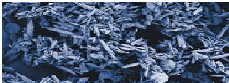
Slika 2.16. Mikroskopski prikaz strukture kamenca 46 .
