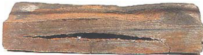
Slika 2.10. Vodikova bolest ugljičnog čelika 32 .
