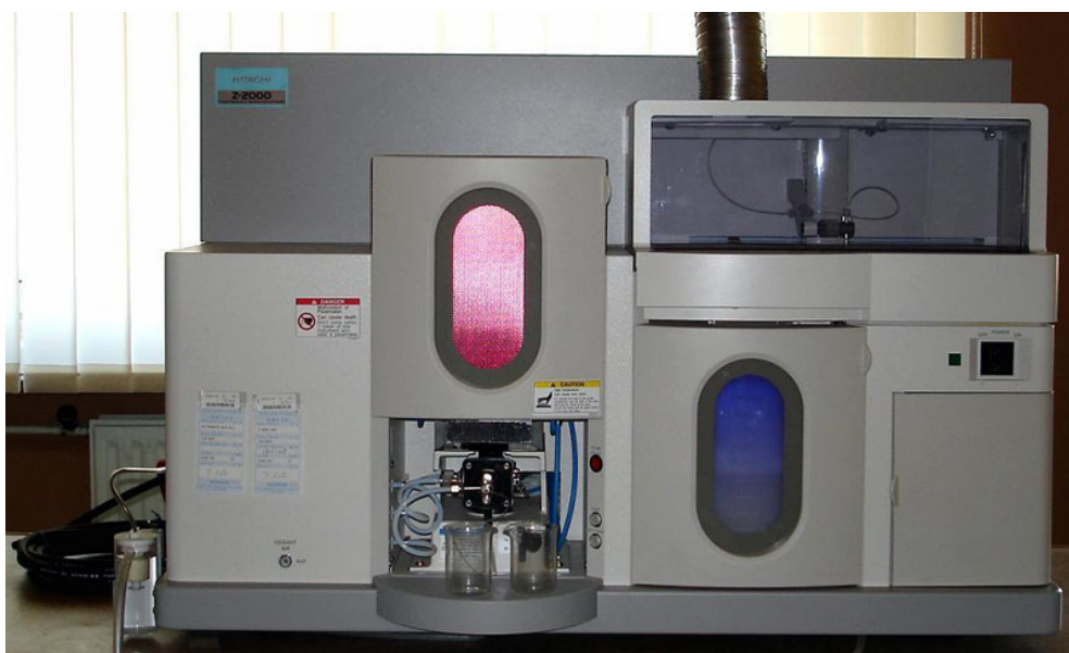
Slika 3.5. Atomski apsorpcijski spektrometar, Hitachi Z–2000.
