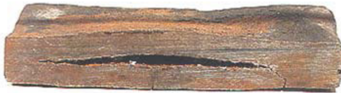
Slika 2.10. Vodikova bolest ugljičnog čelika 32 .
