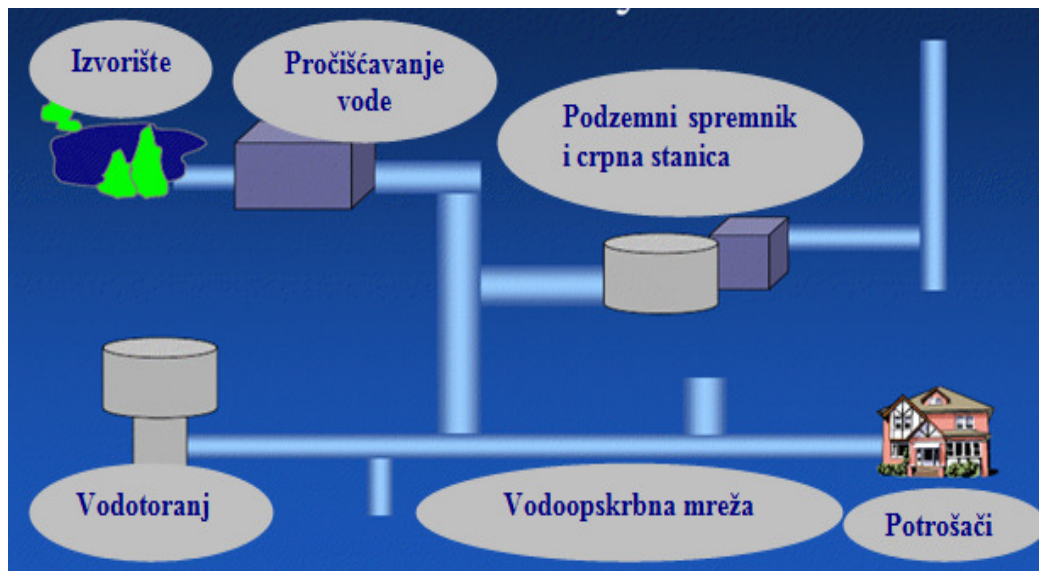
Slika 2.1. Shematski prikaz vodopskrbnog sustava 8 .
