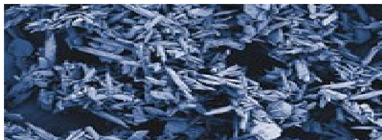
Slika 2.16. Mikroskopski prikaz strukture kamenca 46 .
