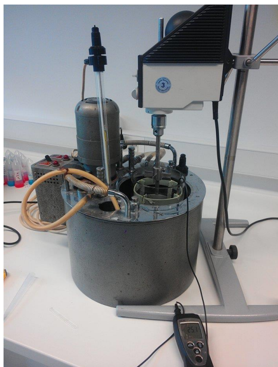
Slika 28. Aparatura za kinetičku analizu sorpcije, Zavod za kemijsko inženjerstvo Kemijsko-tehnološkog fakulteta Sveučilišta u Splitu
