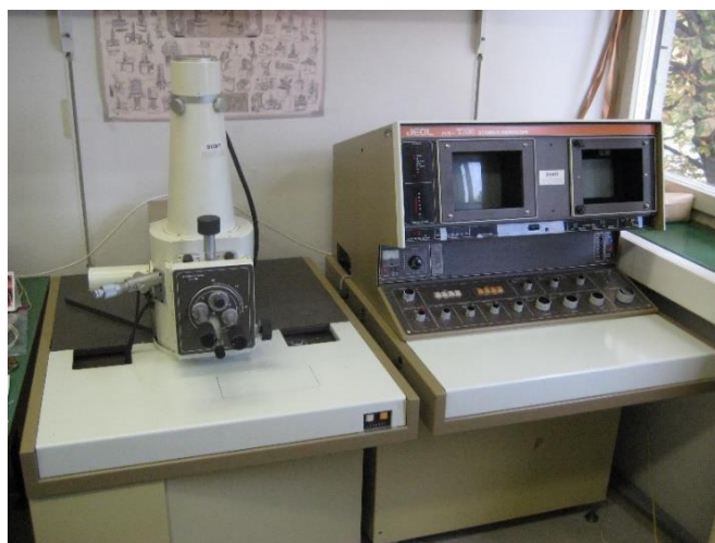
Slika 25. Pretražni elektronski mikroskop, Jeol, model JSM-T300, Laboratorij za molekulsku fiziku Zavoda za fiziku materijala Instituta Ruđer Bošković u Zagrebu
