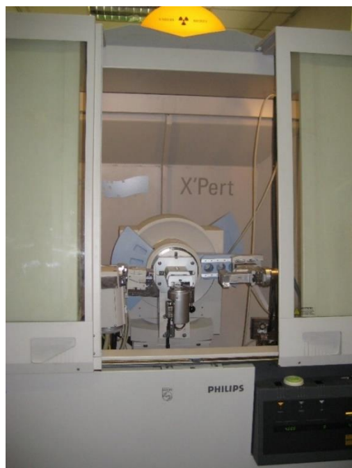
Slika 24. Rendgenski difraktometar, Philips, model PANalytica X'Pert Pro, Mineraloško-petrografski zavod Geološkog odsjeka Prirodoslovno matematičkog fakulteta Sveučilišta u Zagrebu
