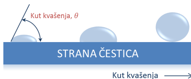
Slika 7. Kut kvašenja strane čestice.
